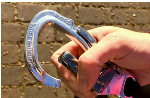
Obr. 36: Mechanismus dlaňových karabin (zdroj: vlastní)
