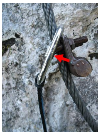
Obr. 19: Působení sil na karabinu při bočním lomu (zdroj: Kublák, 2011)
