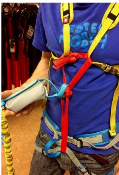
Obr. 15: Připojení tlumiče pádu přes hlavní uzel (zdroj: vlastní)
