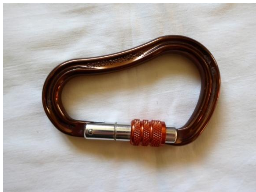
Obr. 37: Šroubovací karabina (zdroj: vlastní)
