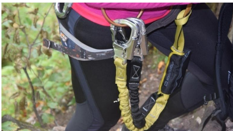
Obr. 4: Tlumič pádu (zdroj: vlastní)
