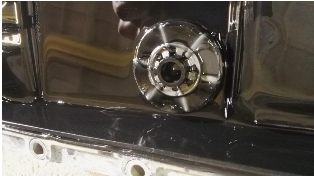
Obr. 13 Magnet zachycující pevné částice v olejové vaně
