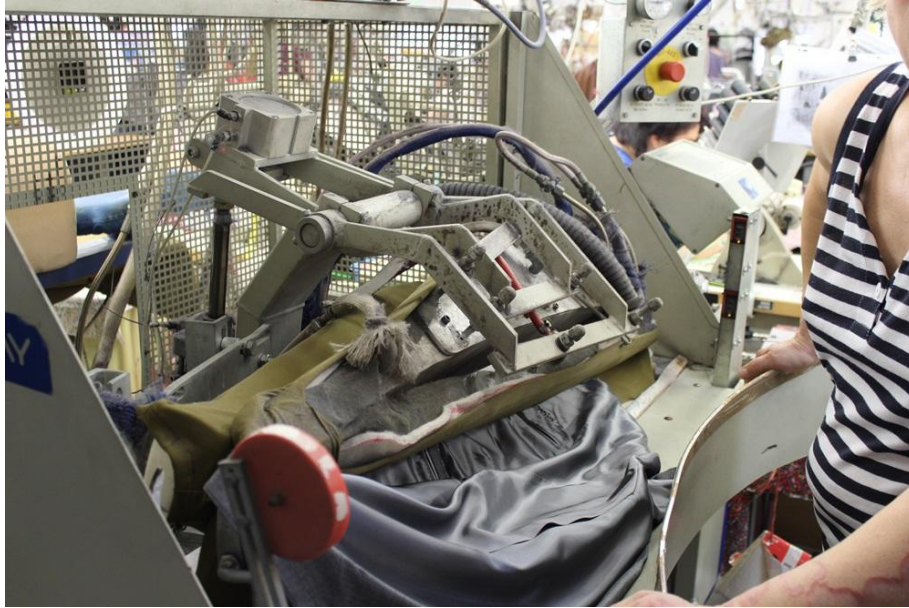
Obrázok 35: Stroj pre žehlenie predných dielov Brisay vyrába Veit
