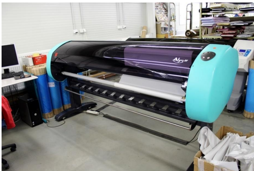
Obrázok 11: Stojanový plotter Lectra Alys 30
