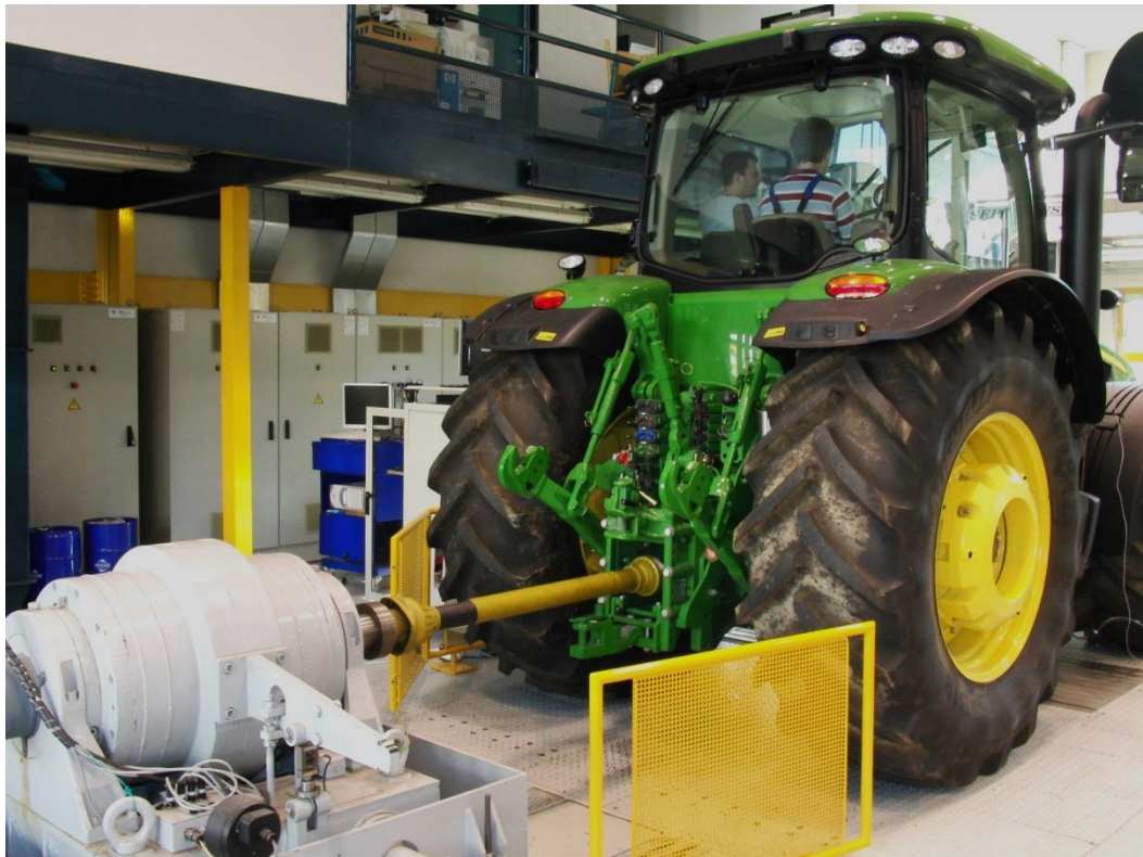
Obr. 4.2 Laboratorní měření otáčkových charakteristik kolového traktoru John Deere 8320R
