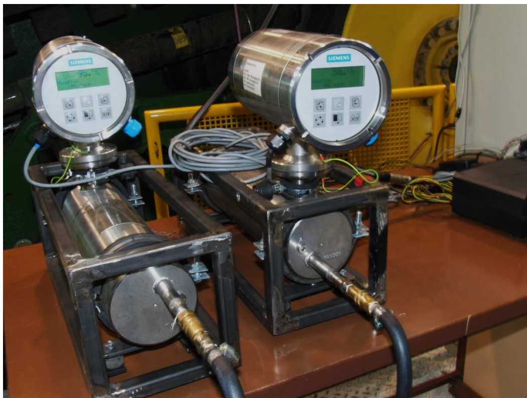
Obr. 4.6 Měření spotřeby paliva pomocí hmotnostních průtokoměrů Coriolis Sitrans FC MassFlo Mass 6000
