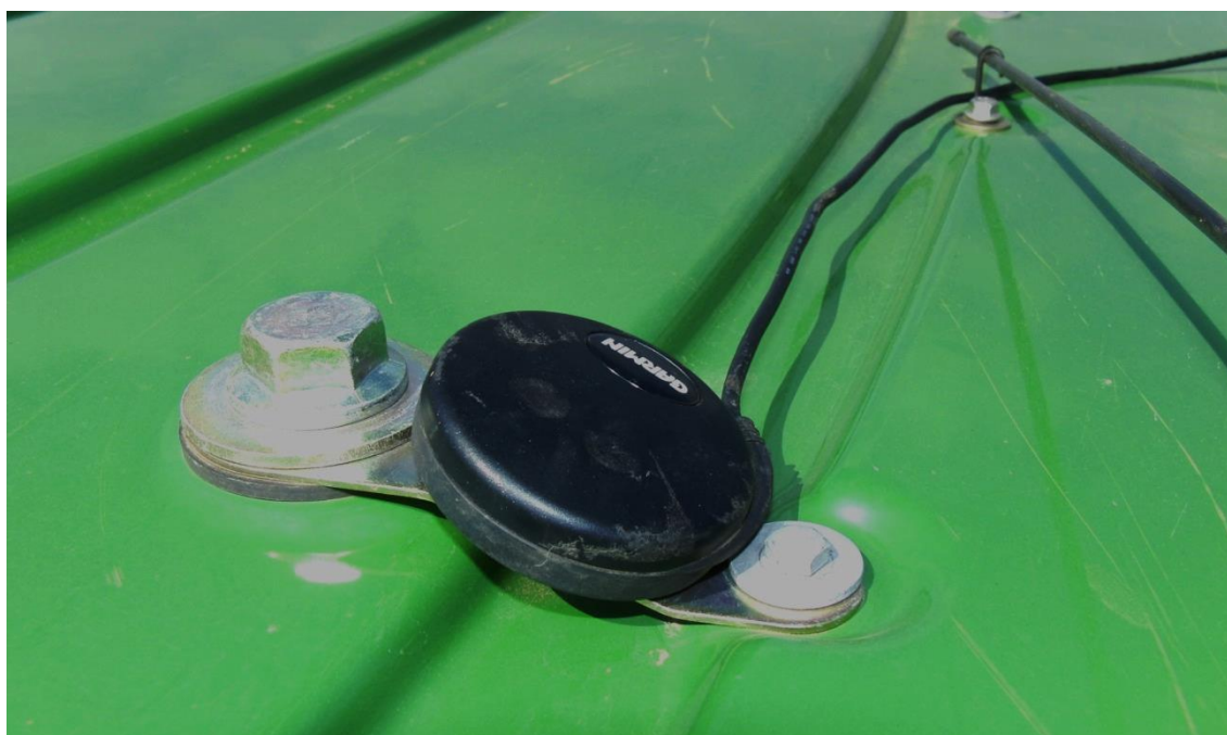
Obr. 4.10 Umístění GPS přijímače na střeše měřeného traktoru
