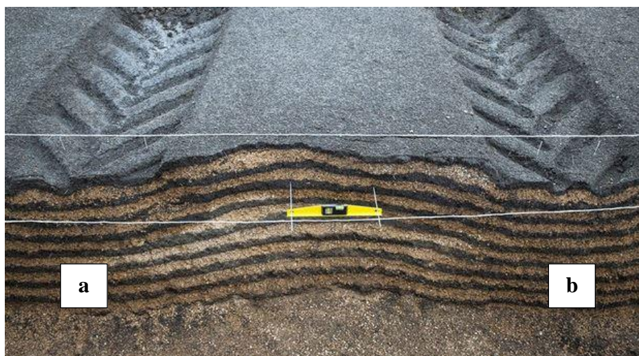
Obr. 3.20 Zhutnění půdy - pneumatika s technologií Ultraflex (a), konvenční pneumatika (b), (informační materiály Michelin)
