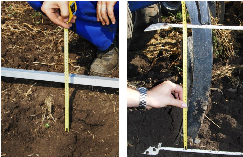
Obr. 4.14 Měření skutečné pracovní hloubky kypřiče Köckerling Vector 800
