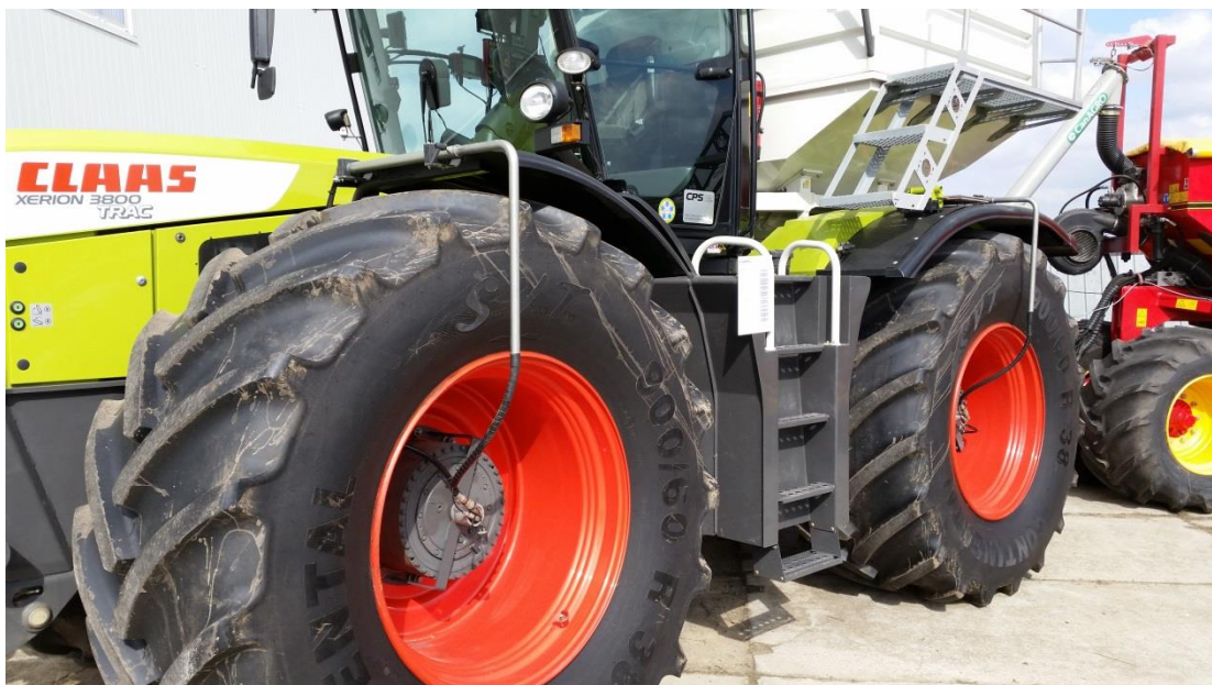
Obr. 3.12 Externí systém centrálního huštění u traktoru Claas Xerion (foto autor)
