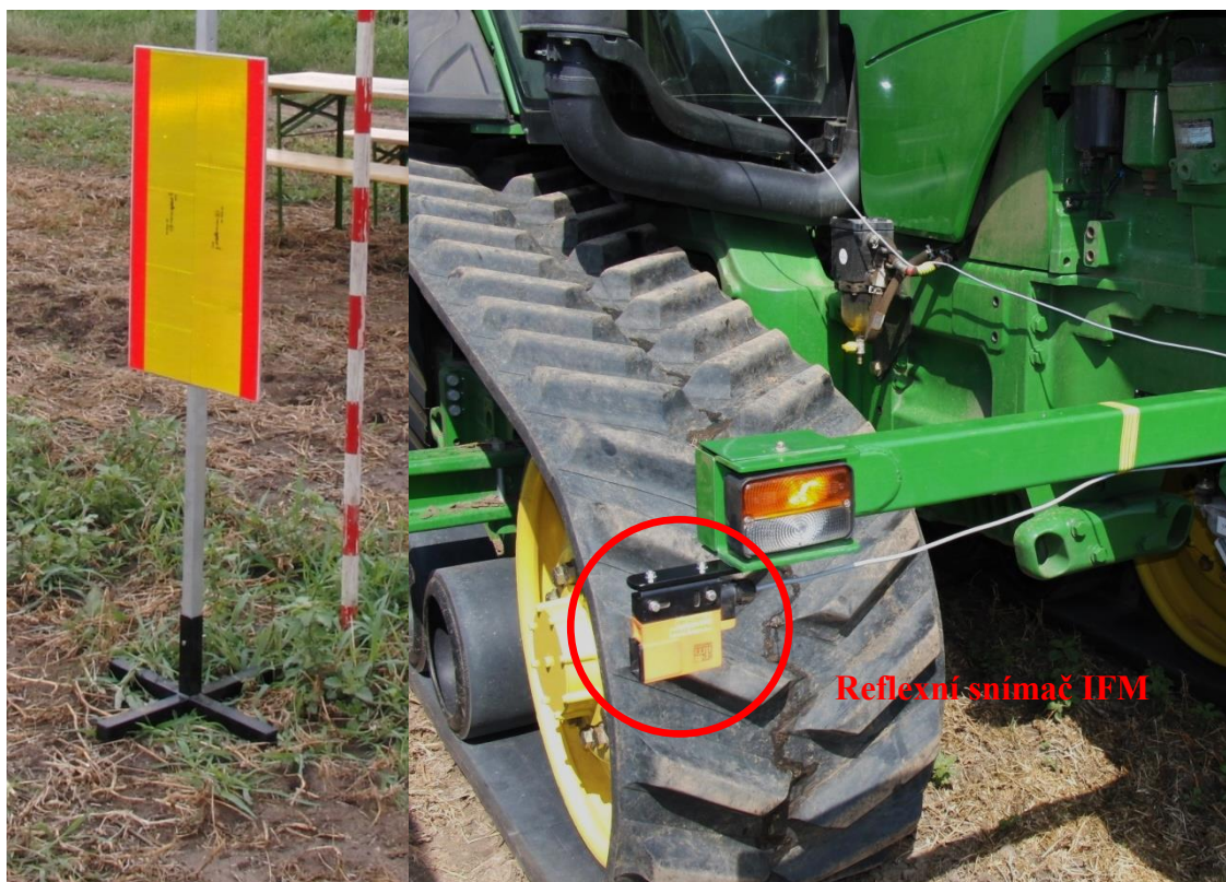
Obr. 4.11 Reflexní snímač umístěný na měřeném traktoru a odrazová plocha
