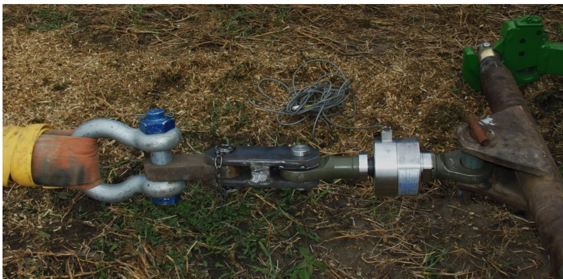
Obr. 4.9 Vložený tenzometrický snímač síly Hottinger U2A mezi měřeným a brzdícím traktorem
