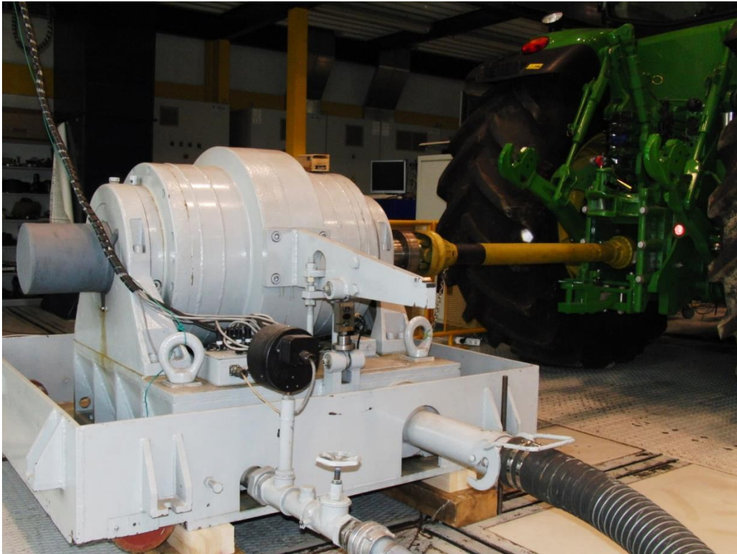
Obr. 4.5 Vířivý dynamometr V 500 připojený k vývodovému hřídeli traktoru
