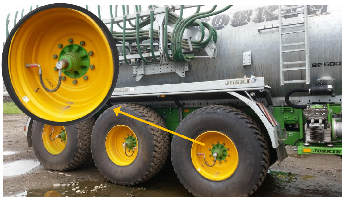
Obr. 3.13 Systém centrálního huštění na přípojném vozidle přes náboj kola (foto autor)
