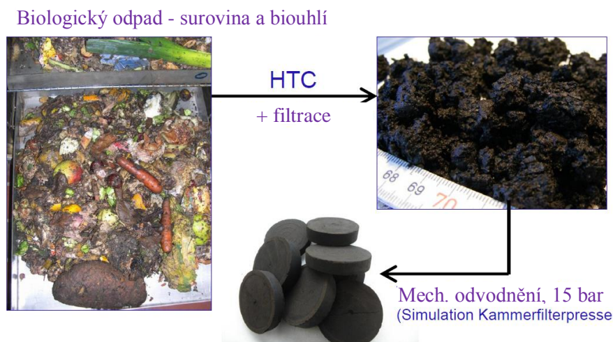
Obr. 15 Ukázka vstupní suroviny (biodpadu) a výstupního produktu (biouhlí) procesu HTC
