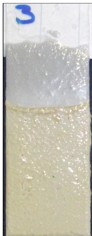
Obr. 4.23 barevná změna nátěru (při působení piva)
