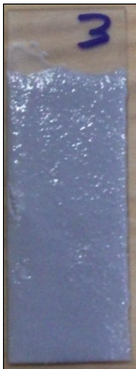
Obr. 4.20 nátěr nevykazuje žádné změny
