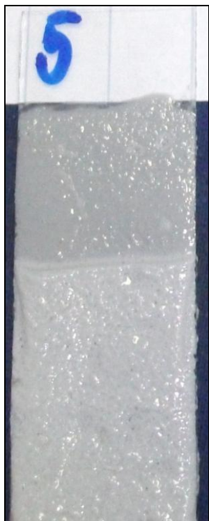
Obr. 4.24 bobtnání nátěru (při působení 20 % vodný roztok NaCl, 5 % vodný roztok NaOH aj.)
