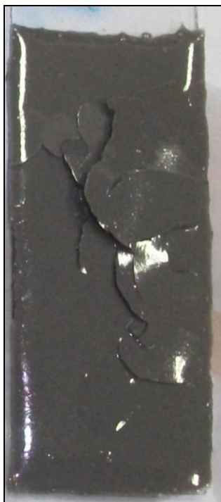
Obr. 4.19 popraskaná struktura nátěru (při působení acetonu)
