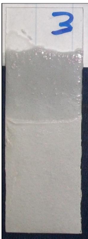
Obr. 4.22 barevná změna nátěru (při působení destilované vody)
