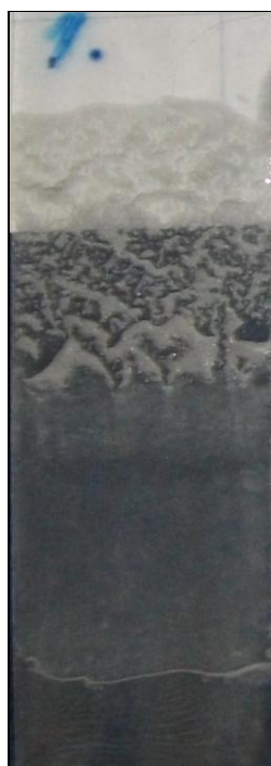
Obr. 4.26 úplné smytí nátěru (při působení acetonu)
