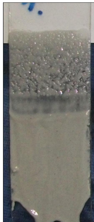
Obr. 4.25 stékání nátěru (při působení benzínu, 50 % vodný roztok etanolu aj.)
