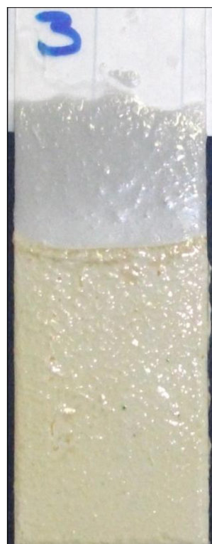
Obr. 4.23 barevná změna nátěru (při působení piva)
