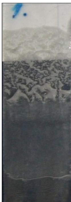
Obr. 4.26 úplné smytí nátěru (při působení acetonu)
