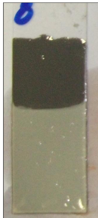
Obr. 4.17 barevná změna nátěru (při působení 20 % vodný roztok H_2SO_4 )
