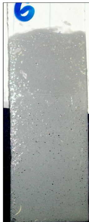
Obr. 4.21 z nátěru se uvolnily zrníčka plniva a vznikla prázdná místa (při působení 30 % vodný roztok NaOH)
