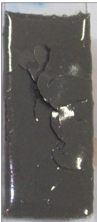
Obr. 4.19 popraskaná struktura nátěru (při působení acetonu)
