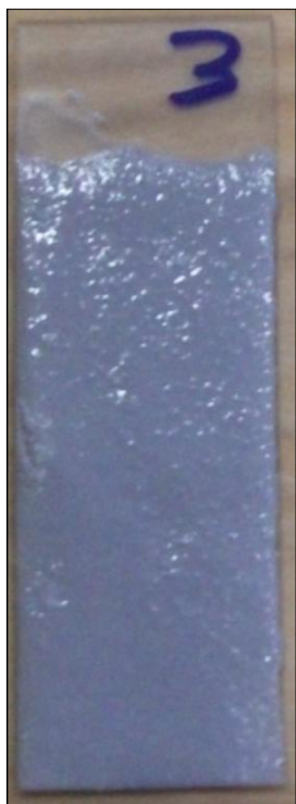
Obr. 4.20 nátěr nevykazuje žádné změny
