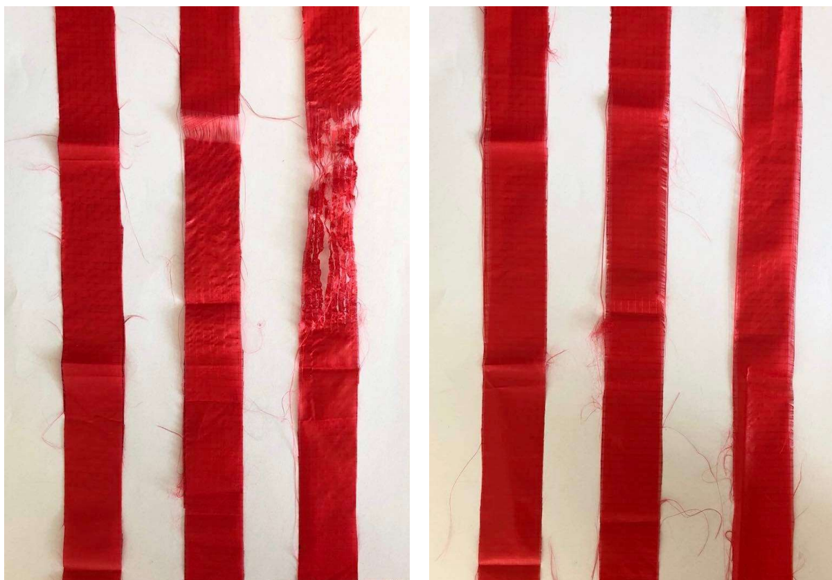
Obrázek 38: Stacionární vzorky po sundání z přístroje, zleva vzorky střiženy po směru osnovy, zprava po směru útku (rychlost 6, 12 a 18 m/s)
