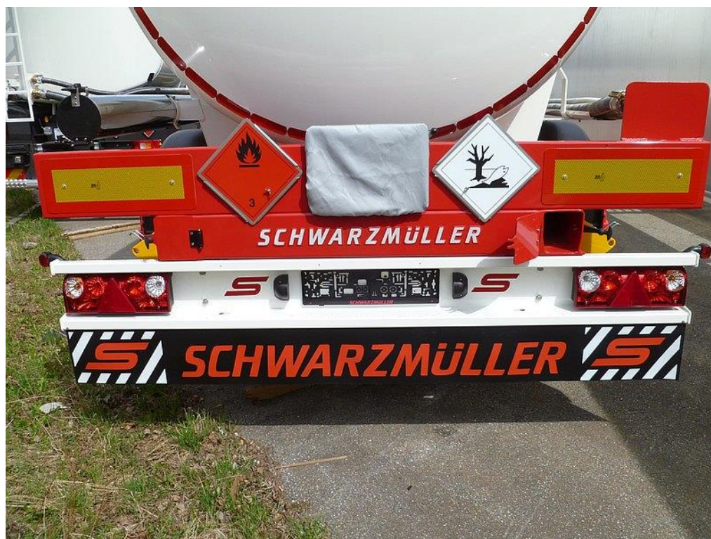
Obr. 4: Označení cisternového vozidla, převážejícího nebezpečné látky (schwarzmueller.com).
