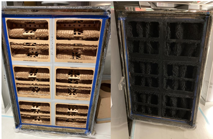
Obrázek číslo 16: Kartonové filtry – nový vs nasycený (zdroj: firma Eisenmann)
