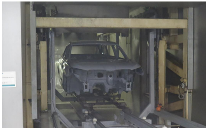
Obrázek číslo 7: oplach, linka VBH (zdroj: foto vlastní)
