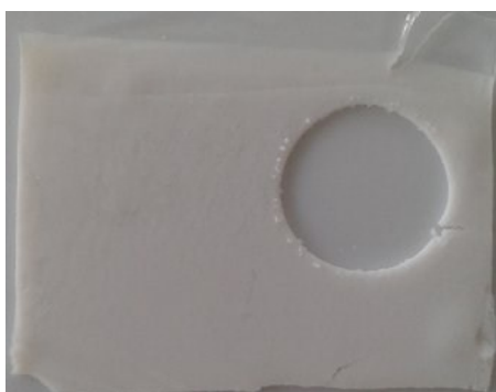
Obr. 16: Vzorek gelu s přidáním \text{Al}_2\text{O}_3 (10 % hmotnostních \text{Al}_2\text{O}_3 )
