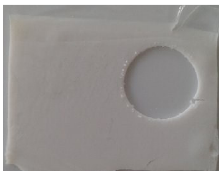
Obr. 16: Vzorek gelu s přidáním \text{Al}_2\text{O}_3 (10 % hmotnostních \text{Al}_2\text{O}_3 )
