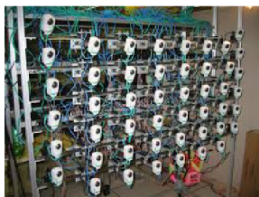
(b) Systém kamer 6 \times 8 s možností dynamického přemístování kamer při snímání light fieldů. Převezato z [21].
