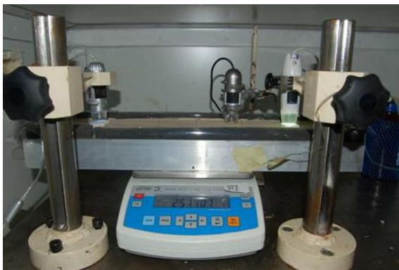
Obrázek 19: pohled na optický dilatometr VUT FAST [1].
