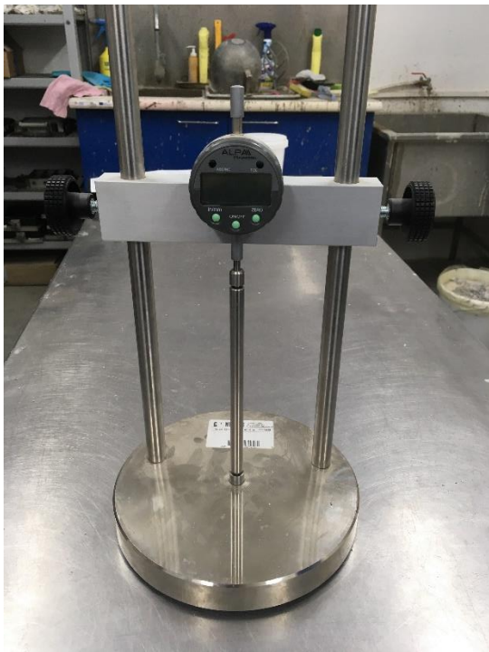
Obrázek 32: Fotografie měřicí sestavy pro měření délkových změn trámečkovou metodou s kalibračním tělesem
