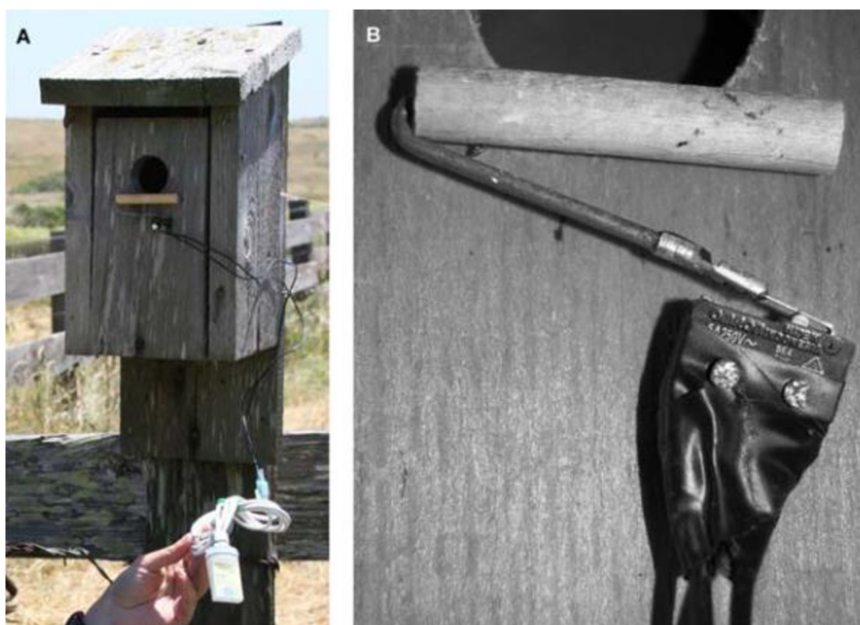
Obrázek 13: Hnízdní budka s připojeným automatickým záznamníkem (Rose 2009)
