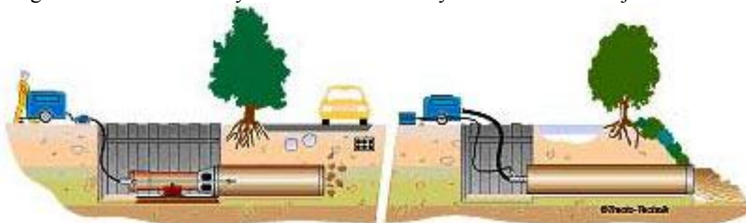
Obr. č. 19 - Beranění ocelového potrubí Grundoram – zdroj (TLAK SMOLÍK s.r.o., 2008)
