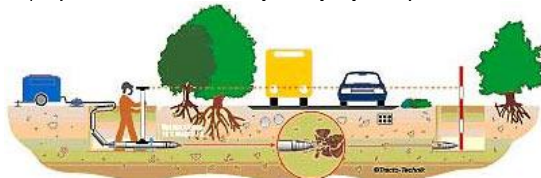
Obr. č. 18 - Neřízená zemní raketa / pneumatické kladivo Grundomat – zdroj (TLAK SMOLÍK s.r.o., 2008)
