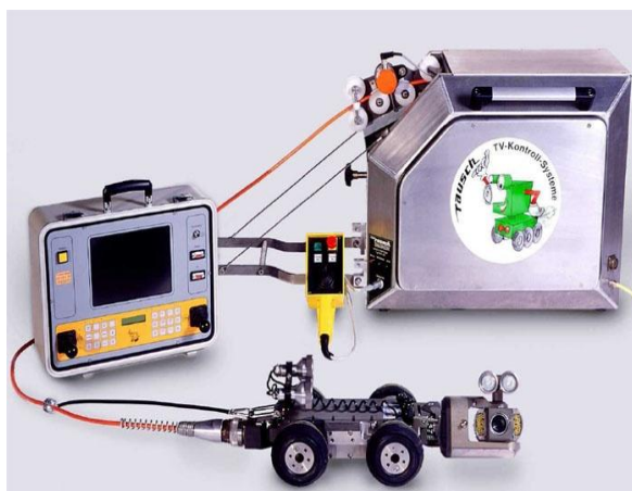
Obr. č. 16 - Kamerový vozík se záznamovým zařízením ECO-Star-Elka 250 – zdroj (Raclavský, 2009)
