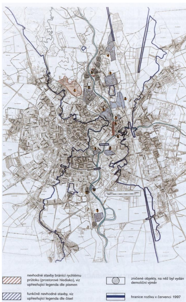
Obrázek 6 - Nevhodné stavby v inundačním území Olomouce; Zdroj: (Konvička, 2002)
