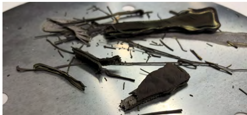
Obrázek 2.18: Rozpadající se těleso v důsledku nevhodných tiskových parametrů
