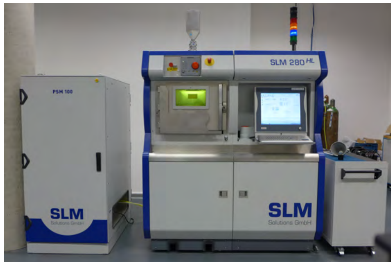
Obrázek 3.3: Stroj SLM 280HL a přesívací stanice PSM 100 od společnosti SLM Solutions Group AG
