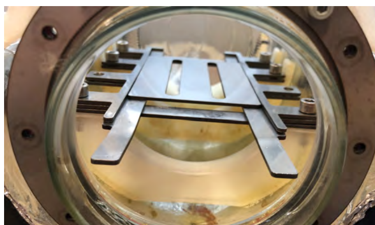
Obrázek 2.15: Vnitřní prostor debinding komory s jednou podkladní deskou pro vzorky
