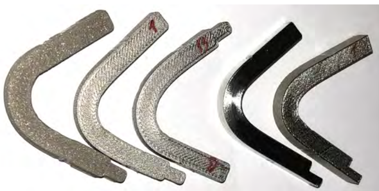
Obrázek 4.6: Zkušební tělesa po rázové zkoušce
