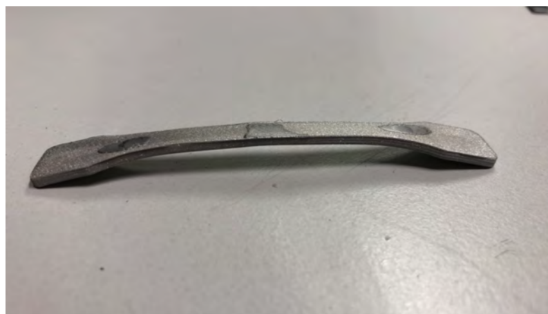
Obrázek 2.19: Prohnutí tělesa po sintraci bez řízeného chlazení
