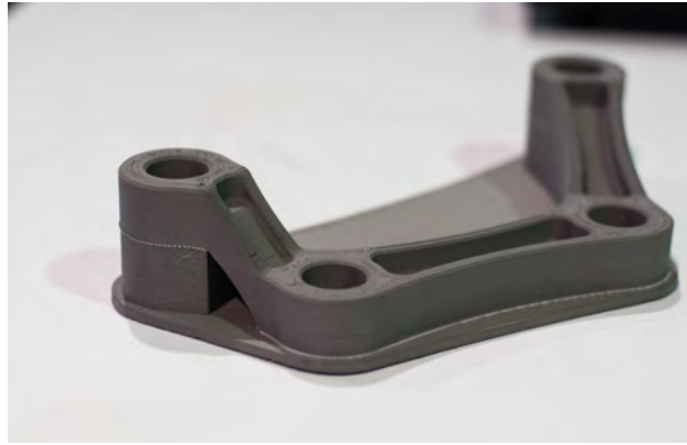
Obrázek 1.6: Výrobek technologie ADAM společnosti Markforged, Inc. z materiálu AISI 17-4PH s podpůrnou strukturou a separační vrstvou [17]
