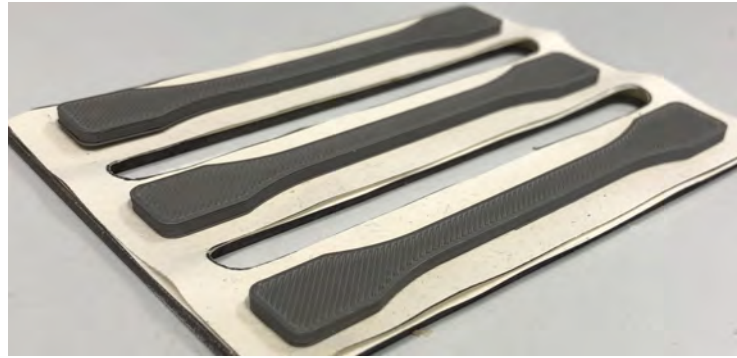
Obrázek 2.16: Vzorky na podkladní desce ihned po debinding procesu
