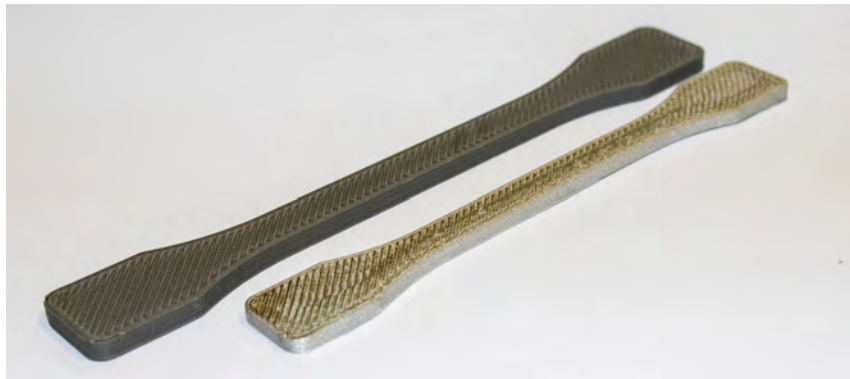
Obrázek 6.4: Tahové těleso tištěné z Ultrafuse 316LX, po tisku a po sintraci
