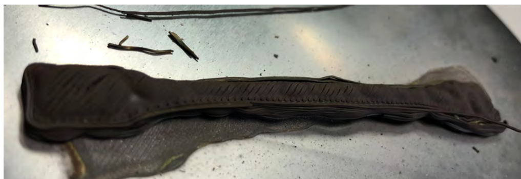
Obrázek 2.8: Těleso po teplotním debinding procesu se sintací ve vakuové peci
