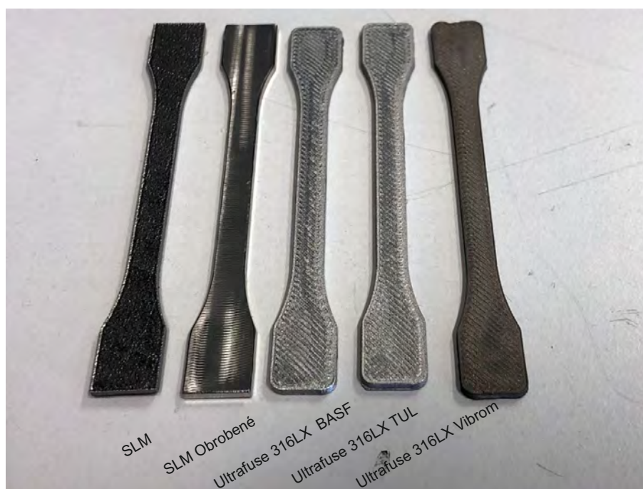
Obrázek 4.1: Zástupci všech zkušebních sad pro test statickým tahem
