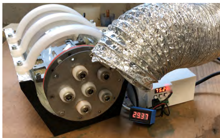
Obrázek 2.14: Fotografie celé sestavy debinding komory po jejím dokončení
