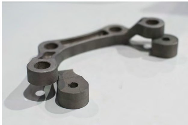
Obrázek 1.7: Výrobek technologie ADAM společnosti Markforged, Inc. z materiálu AISI 17-4PH po odstranění podpůrné struktury [17]
