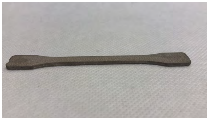
Obrázek 2.20: Sintrované těleso dle konečných parametrů procesu pro zpracování Ultrafuse 316LX
