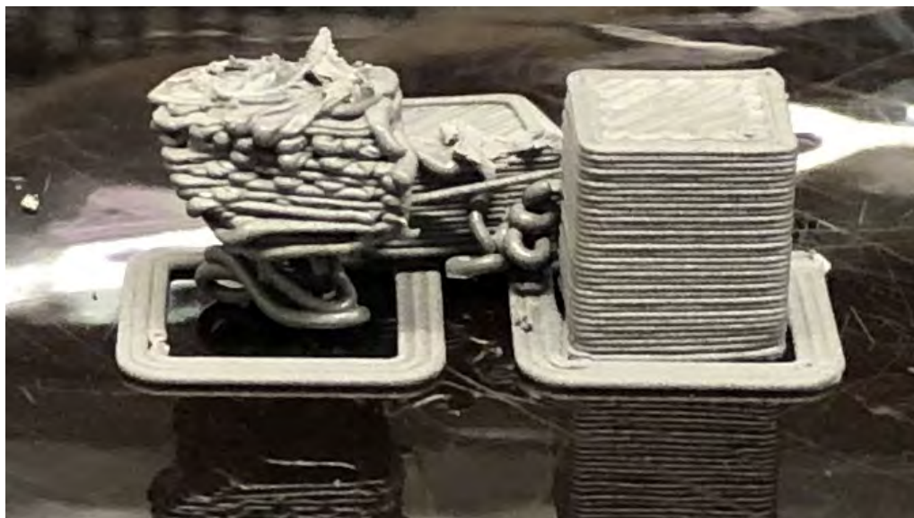
Obrázek 2.6: Dvě kostičky velikosti 6×6×8 mm tištěné na kaptonovou fólii dle doporučení společností BASF
