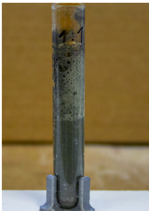
Obrázek 2.9: Reakce materiálu Ultrafuse 316LX s ředěnou kyselinou dusičnou 1:1 s vodou
