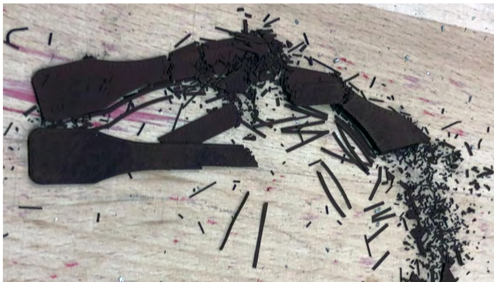
Obrázek 2.7: Těleso po teplotním debindingu procesu (první experiment v běžné peci)
