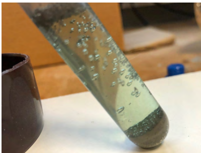
Obrázek 2.10: Materiál Ultrafuse 316LX rozpuštěný v kyselině dusičné
