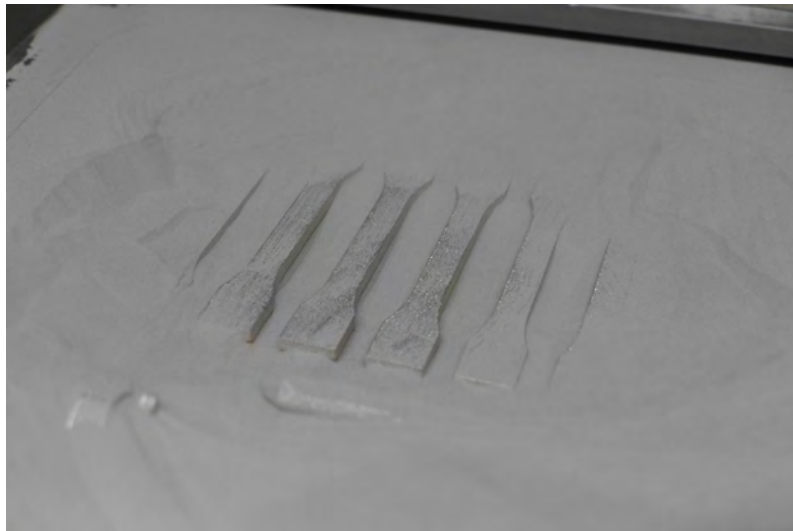
Obrázek 3.9: Táhová tělesa z materiálu AISI 316L při začátku odstraňování volného prášku z prostoru stroje
