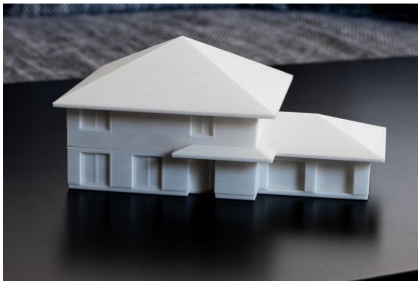
Obrázek 76 - Vytisknutý referenční model na tiskárně Průša i3 MK3S+ Zdroj: Vlastní zpracování
