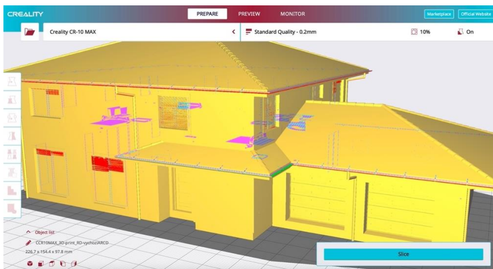
Obrázek 37 - Referenční model z programu Archicad po importu do pracovního prostředí sliceru Creality
