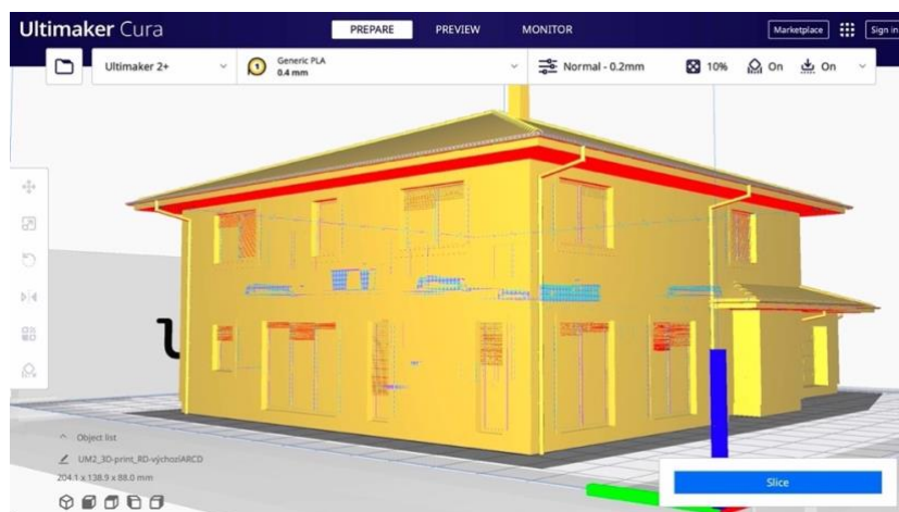
Obrázek 34 - Referenční model z programu Archicad po importu do pracovního prostředí sliceru Cura
