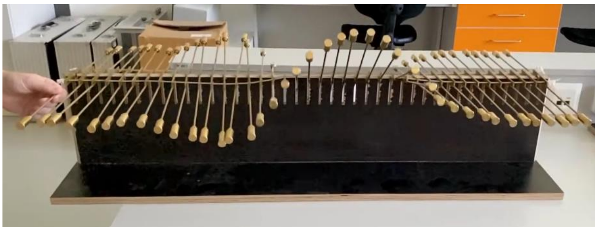
Obr. 2: Vlna šířící se směrem k volnému konci po zhotoveném vlnostroji. Rychlost vlnění byla změřena pomocí rychlokamery jako v \cong 1,2 \text{ m}\cdot\text{s}^{-1} .
