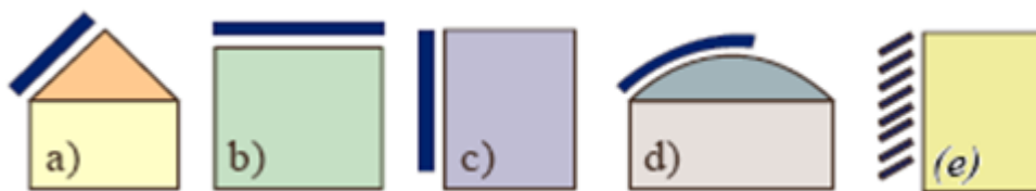
Obr. č. 10: Schématické znázornění způsobů integrace kolektorů do budov: (a) šikmá střecha, (b) plochá střecha, (c) fasáda, (d) tenkovrstvé kolektory pro velké střešní plochy, (e) vnější stínící a clonící systémy. (zdroj:www.abs-portal.cz)
