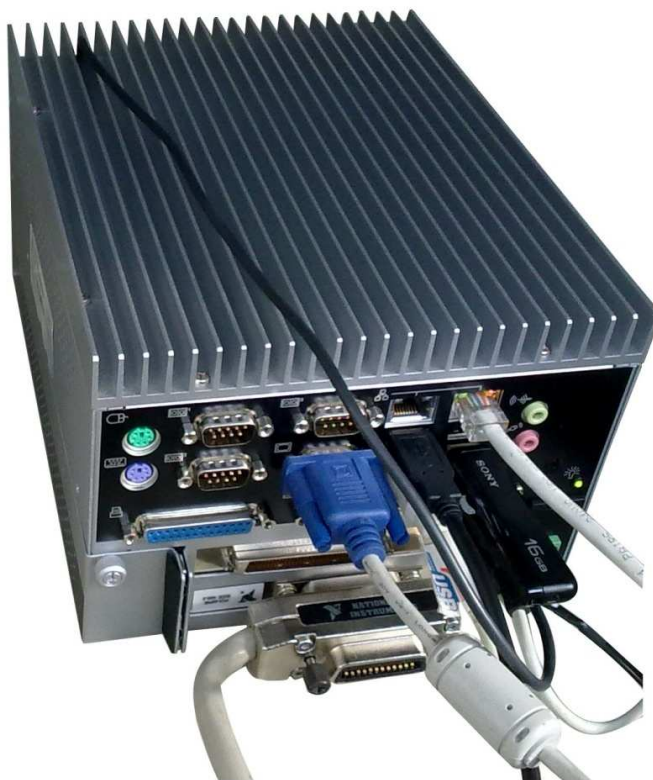
Obrázek 16: Průmyslový počítač Axiomtek eBOX639-822-FL
