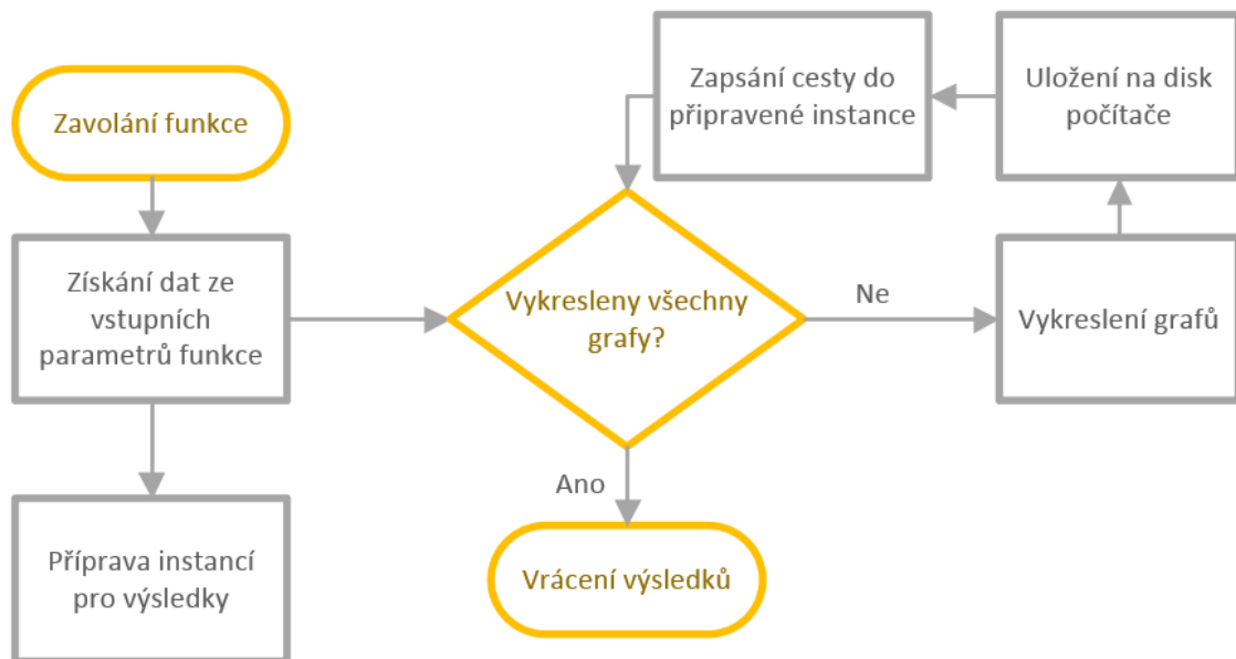
Obrázek 6: Diagram zjednodušené funkce MATLAB scriptů
