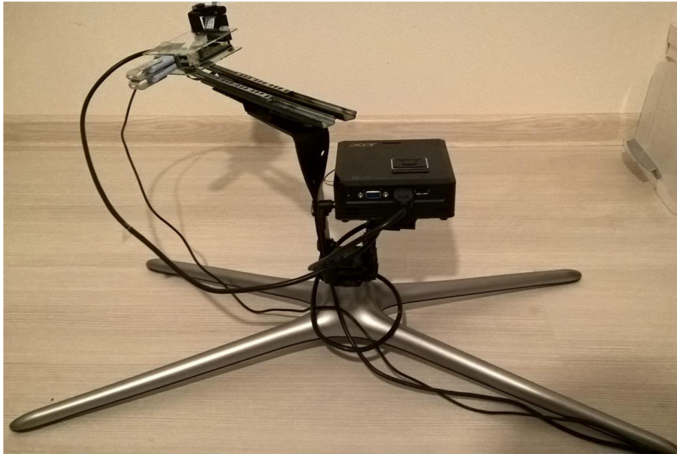
Obrázok 4: Stojan vytvorený pre prepojenie jednotlivých prístrojových častí
