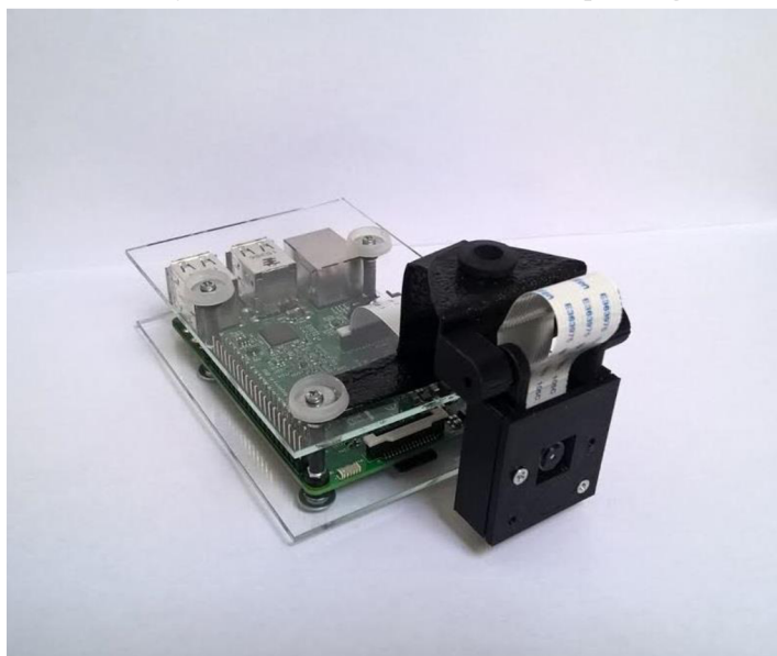
Obrázok 5: Konštrukčné riešenie obalu na Raspberry + kameru
