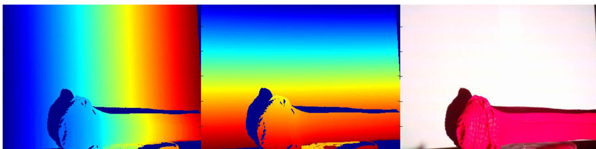
Obrázok 58: Nasnímanie krepového papiera pri meraní detailnosti objektu
