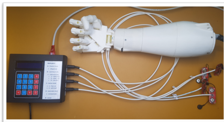
Obrázek 21 – propojená řídicí jednotka s modelem končetiny
