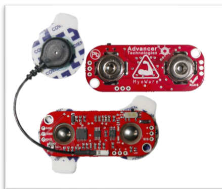
Obrázek 17 – EMG zesilovač MyoWare, převzato z [1]
