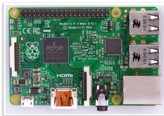
Obrázek 15 – Raspberry Pi 2 B, převzato z [54]
