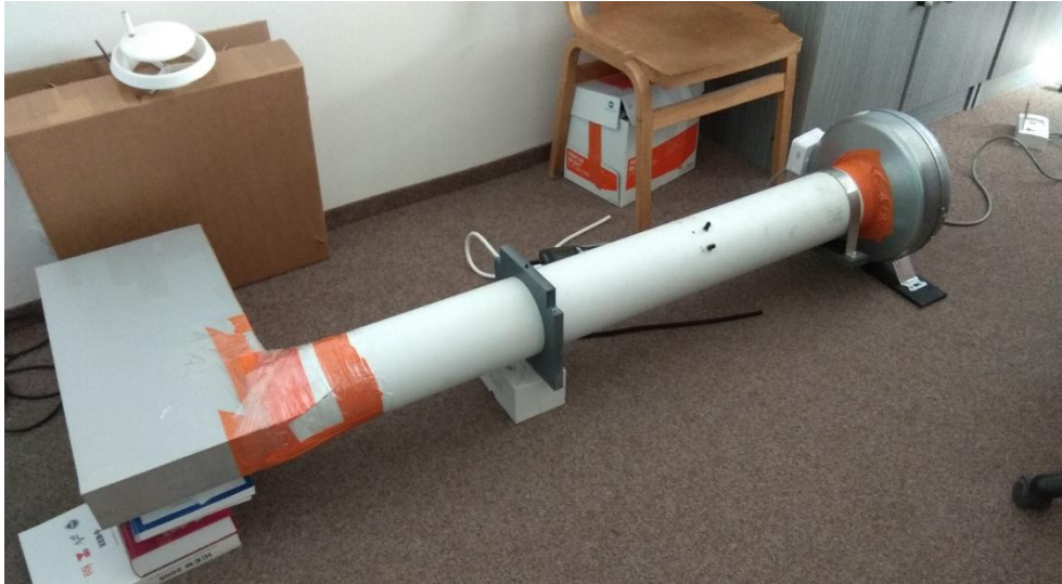
Obrázek 3.11-2: Měření tlakových ztrát \frac{1}{4} chladicího žebra.
