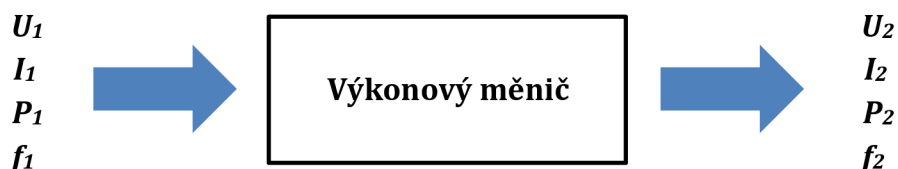
Obrázek 2.1: Výkonový měnič jako základní funkční jednotka – převzato a upraveno. [1]
