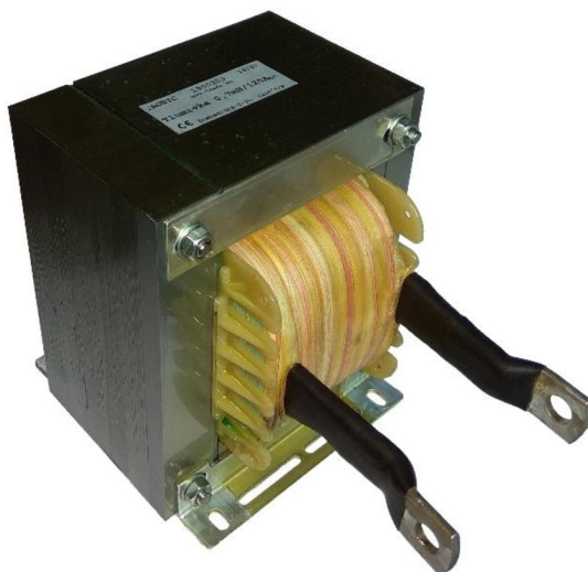
Obrázek 3.12: Realizovaná výkonová tlumivka 0,7 mH/120 A.
