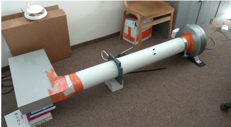
Obrázek 3.11-2: Měření tlakových ztrát \frac{1}{4} chladicího žebra.
