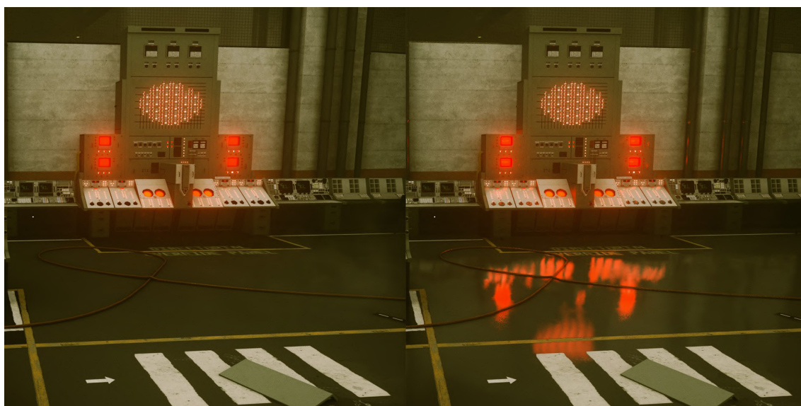
Obr. 44: Srovnání obrazu s vypnutou (vlevo) a se zapnutou (vpravo) funkcí screen space odlesků ze hry Control. Srovnání vytvořeno autorem práce na základě předdefinovaných nastavení této hry.
