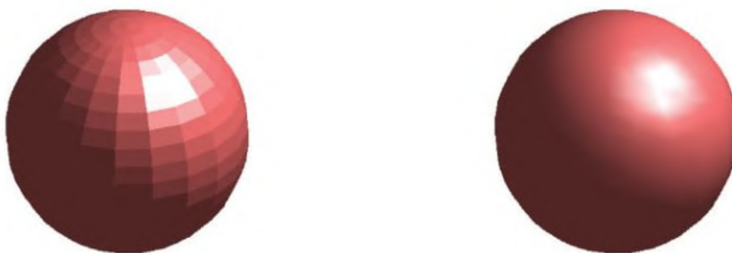
Obr. 35: Koule nasvícená ploše (vlevo) a Gouraudovou metodou (vpravo). [144]
