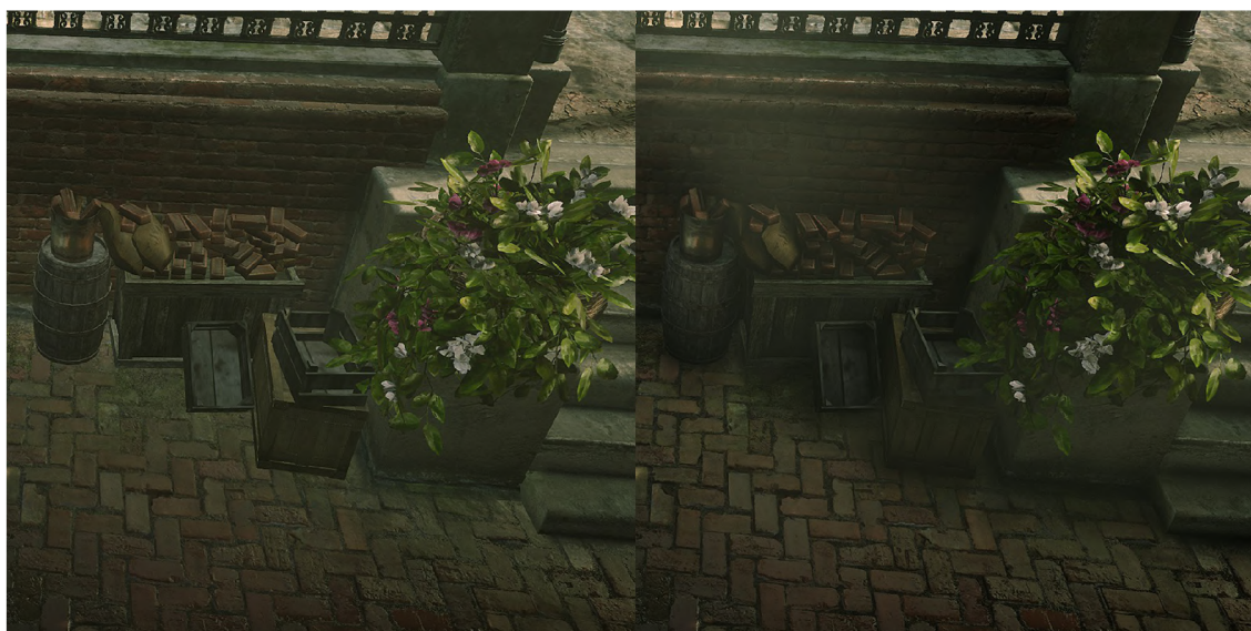
Obr. 43: Srovnání obrazu s vypnutou (vlevo) a se zapnutou (vpravo) funkcí SSAO ze hry Red Dead Redemption 2. Srovnání vytvořeno autorem práce na základě předdefinovaných nastavení této hry.
