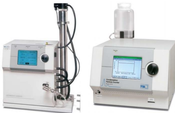
Obr. 5-3 Elektrostatický klasifikátor 3080 s DMA Long (zleva) a CPC 3775 (zprava) [70, 71]
