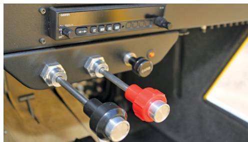
Obr. 3.1.2 - ovládání táhla korekce směsi v kabině
