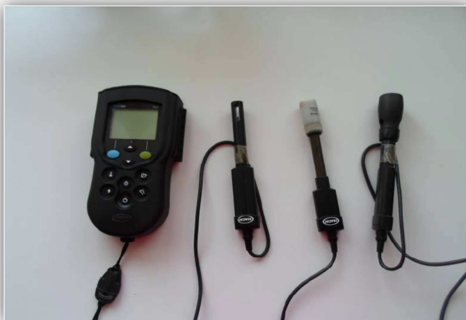
Obr. 2: Jednokanálový multimetr HQ30D s výměnnými elektrodami (Foto AUTOR, 2016)
