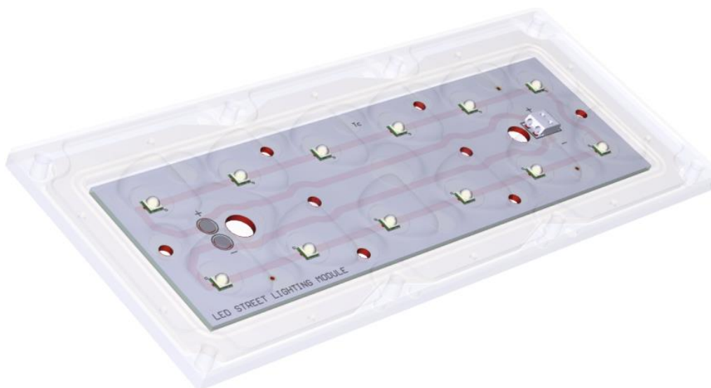
Obrázok 5.2 3D model LED modulu a optiky STRADA 2x6
