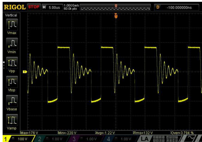
Obrázok 8.2 Priebeh napätia U_{L1} na induktore L_1
