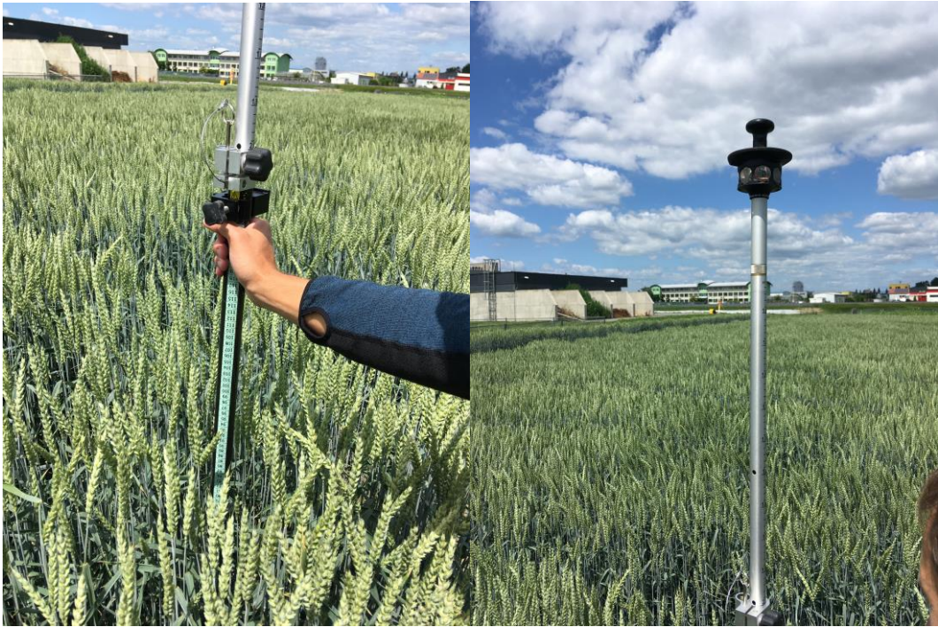
Obr. 6.3.1.1 Manuální zaměřování výšek pomocí výtyčky s měřicí páskou
