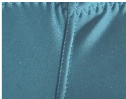
Obr. 11: Ukázka dvojitého přeplátovaného švu [foto vlastní]
