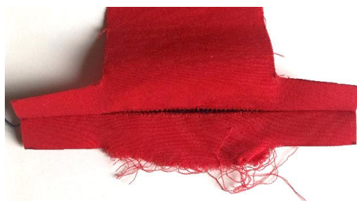
Obr. 32 Vzorek měřený metodou Strip – příčná pevnost [foto vlastní]
