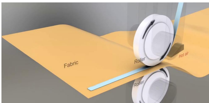
Obr. 23: Nanesení adheziva na materiál ve formě pásky [28]
