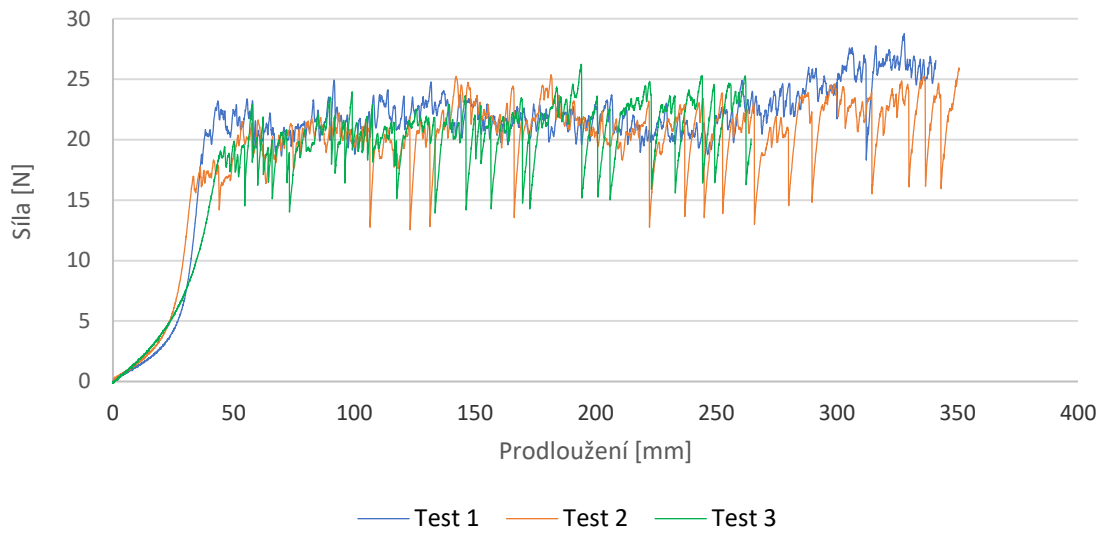
Diagram delaminace - po 30 cyklech namáhání
