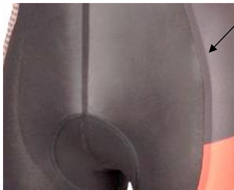
Obr. 12 Ukázka adhezivně pojeného švu [9]
