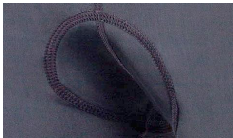
Obr. 14 Všití vložky krycím stehem třídy 600 [9]
