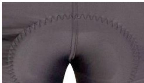
Obr. 13: Všití vložky klikatým vázaným stehem třídy 300 [6]
