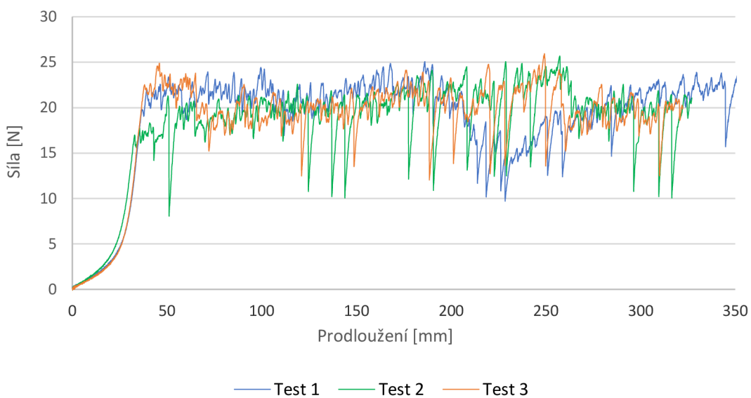
Diagram delaminace - po 45 cyklech namáhání
