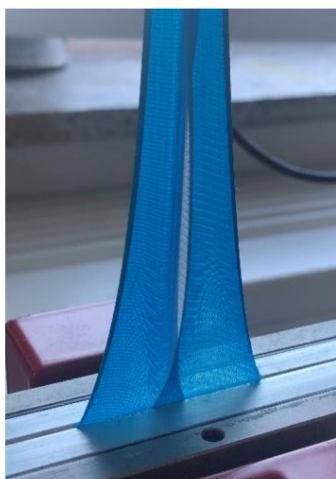
Obr. 35: Šev s upravenou šířkou na 50 mm pro podélnou pevnost
