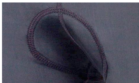
Obr. 14 Všití vložky krycím stehem třídy 600 [9]
