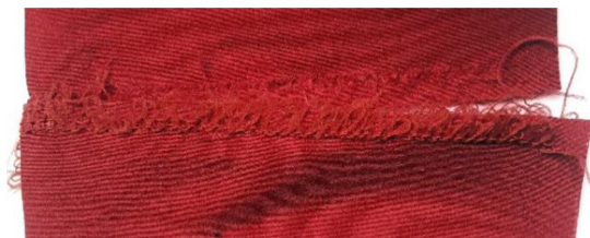
Obr. 34 Vzorek upnutý v celé šíři o rozměrech pro metodu Grab [foto vlastní]
