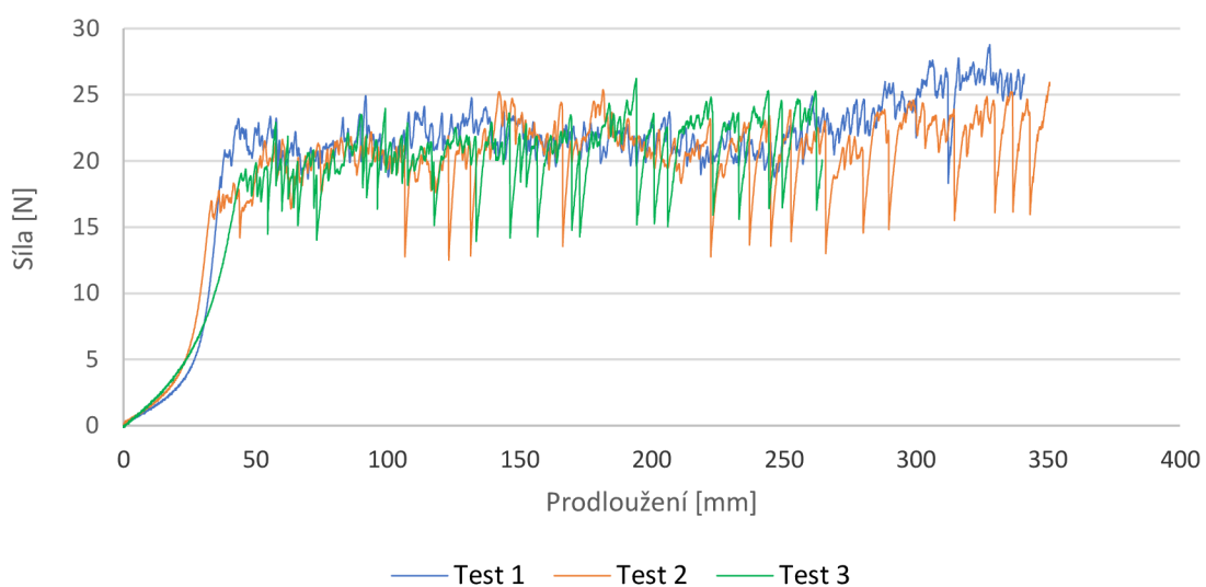
Diagram delaminace - po 30 cyklech namáhání
