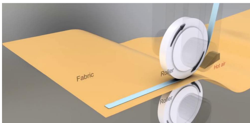
Obr. 23: Nanesení adheziva na materiál ve formě pásy [28]
