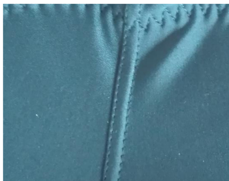
Obr. 11: Ukázka dvojitého přeplátovaného švu [foto vlastní]
