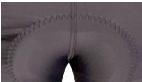
Obr. 13: Všití vložky klikatým vázaným stehem třídy 300 [6]
