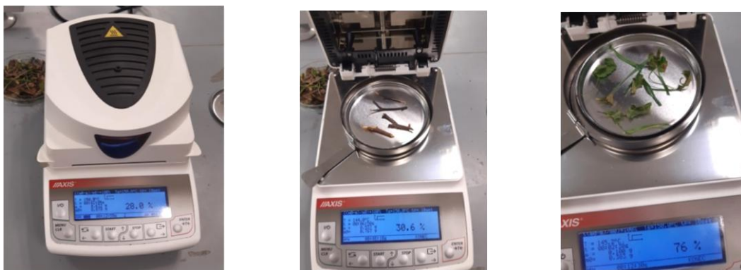
Obrázek 10: Laboratorní zpracování vzorků pomocí analyzátoru vlhkosti (foto: M. Olszewiczová)
