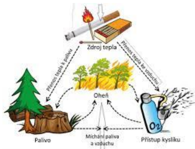
Obrázek 1: Trojúhelník hoření (Berčák et al., 2018)
