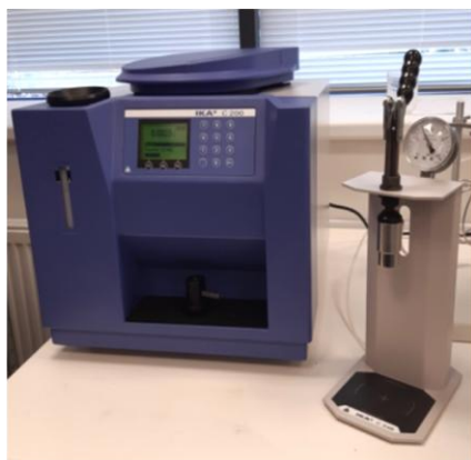
Obrázek 13: Kalorimetr IKA C200 a plnicí kyslíková stanice (vlevo), rozkladná tlaková nádoba (vpravo) (foto: M. Olszewiczová)
