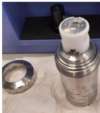
Obrázek 13: Kalorimetr IKA C200 a plnicí kyslíková stanice (vlevo), rozkladná tlaková nádoba (vpravo) (foto: M. Olszewiczová)
