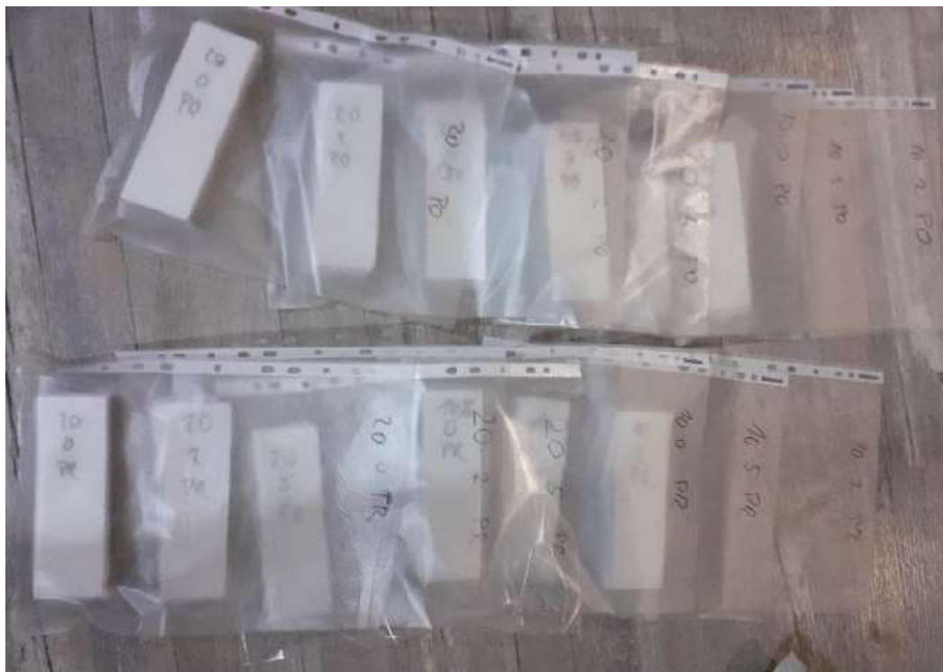
Obr. 23 Vyrobené vzorky z 6 variant po 6ks, před zkouškou
