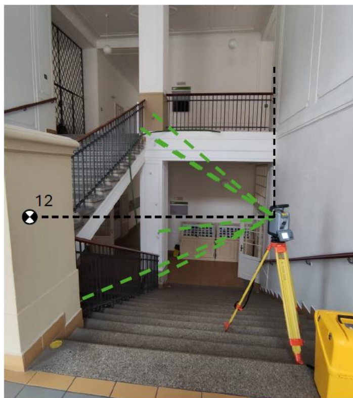
Obr. 18: Schéma kalibračního měření
