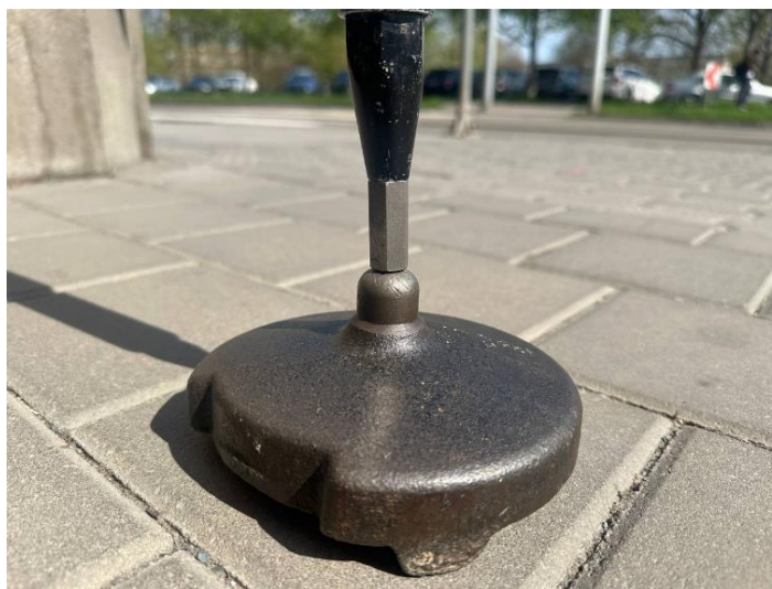
Obr. 29: Tyč s hranolem na nivelační podložce
