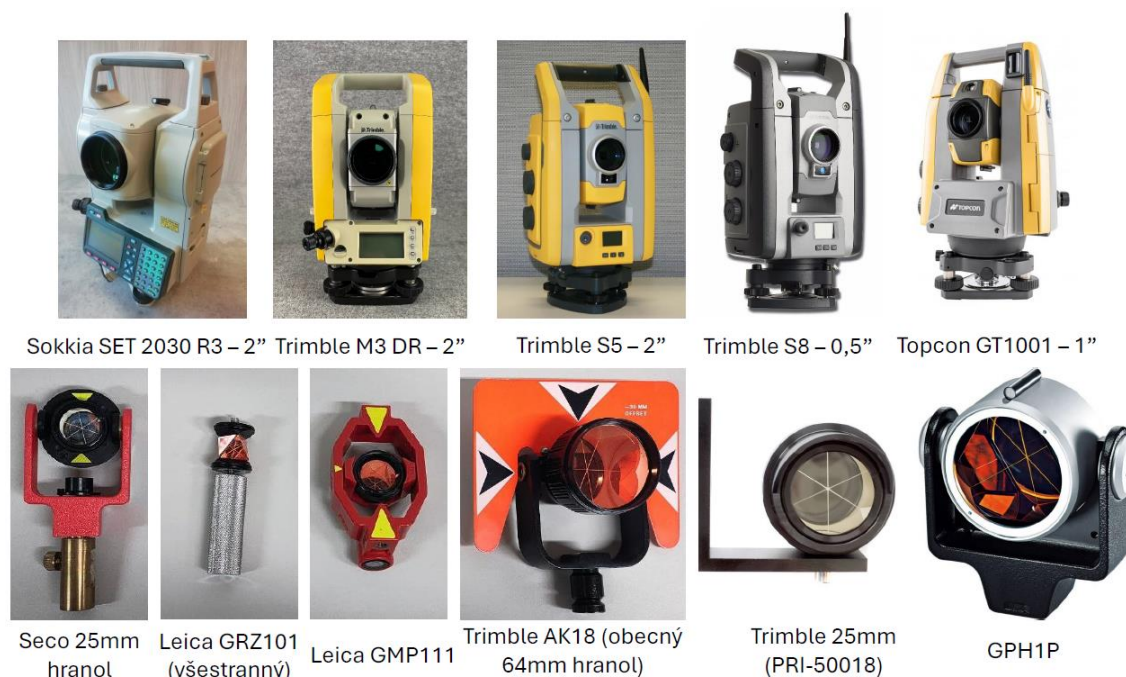
Obr. 14: Použité totální stanice a odrazné hranoly
