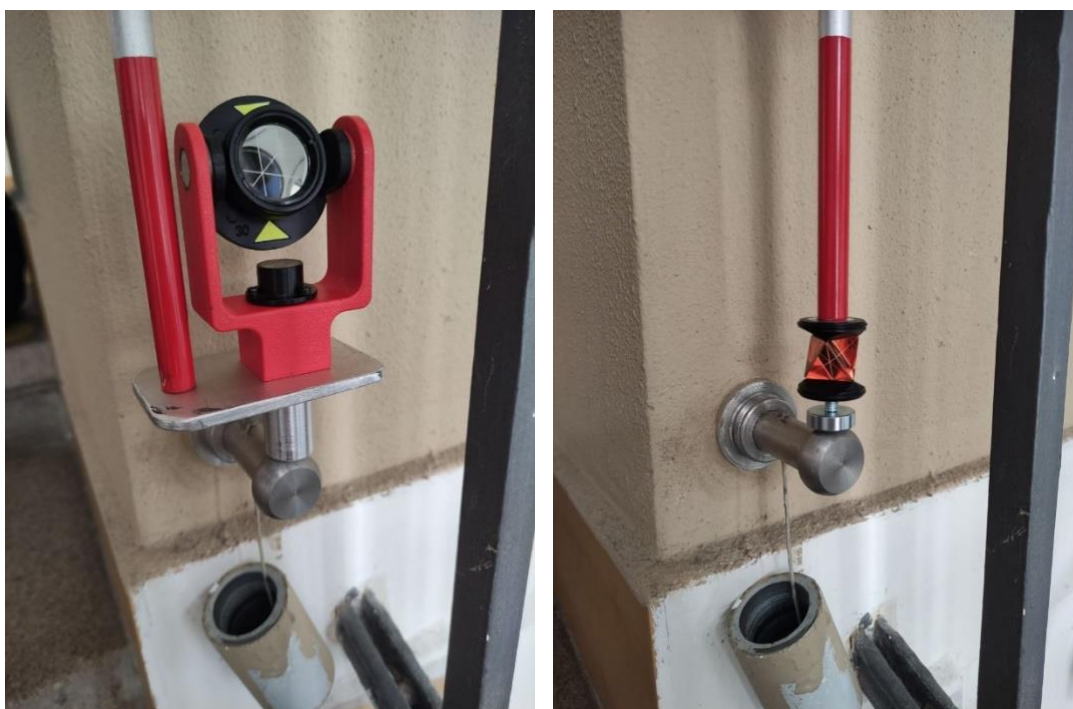
Obr. 26: Hranoly Seco 25mm (vlevo) a Leica GRZ101 (vpravo) umístěné na bodě základny
