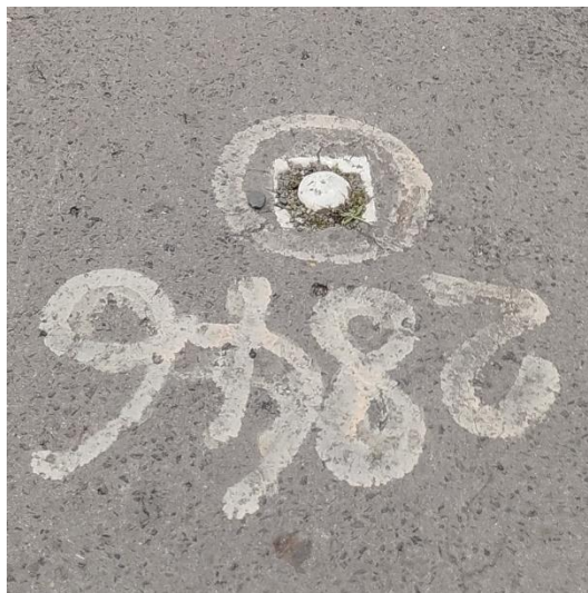
Obr. 40: Stabilizace bodu železničního bodového pole (ŽBP)
