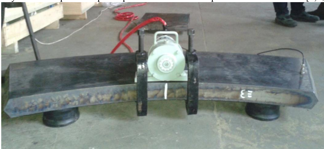
Obr. 2. 9 Zariadenie na odstraňovanie napätí pomocou vibrácií.[11]
