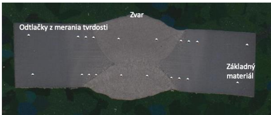
Obr. 3. 5 Príklad merania tvrdosti na makrovýbruse zvaru. [32]
