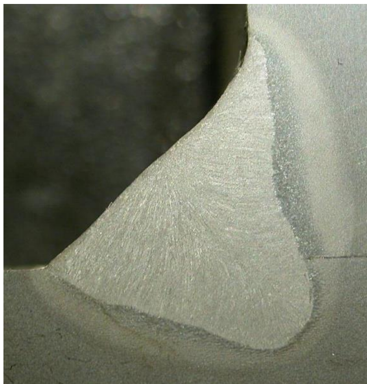
Obr. 2. 1 Kútový zvar vytvorený tavným zváraním.[3]
