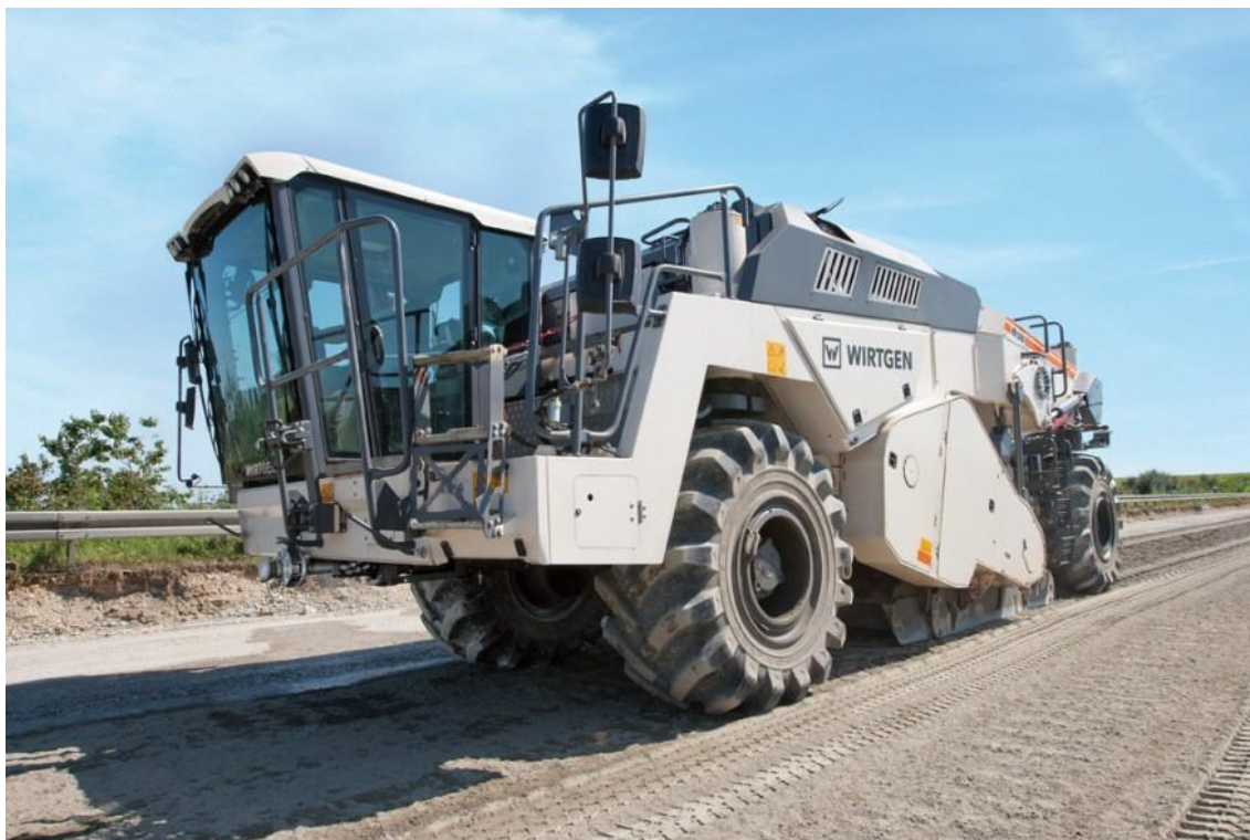
Obrázek 9: Recyklační fréza pro recyklaci za studena WIRTGEN (9)
