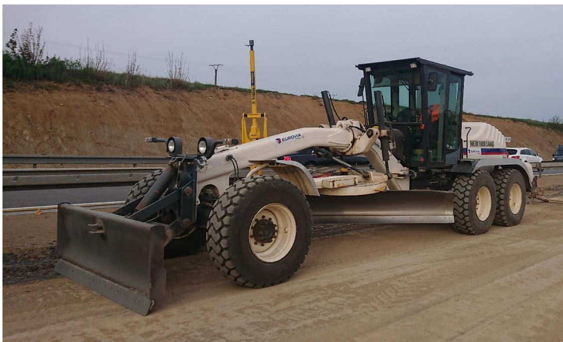
Obrázek 18: Grejdr vybaven příčnou a podélnou nivelací (12)
