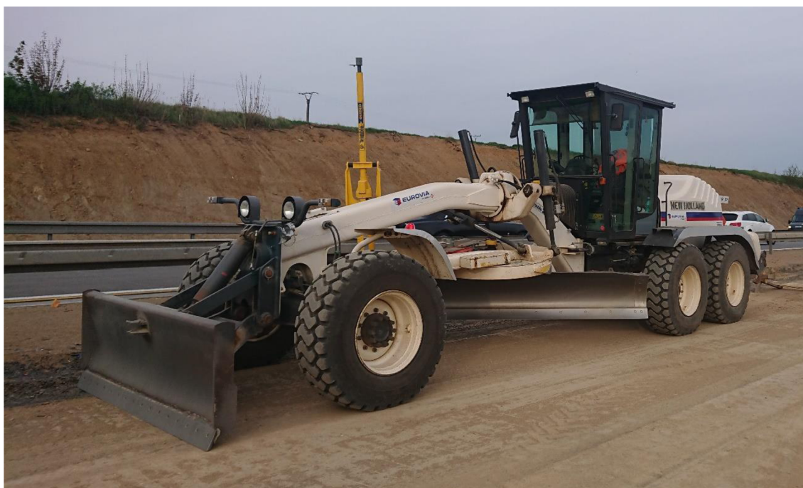
Obrázek 18: Grejdr vybaven příčnou a podélnou nivelací (12)
