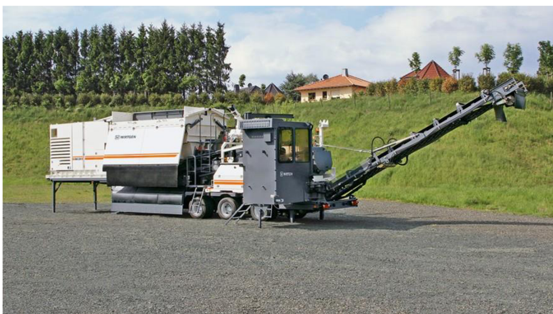
Obrázek 7: Mobilní míchací jednotka WIRTGEN (6)
