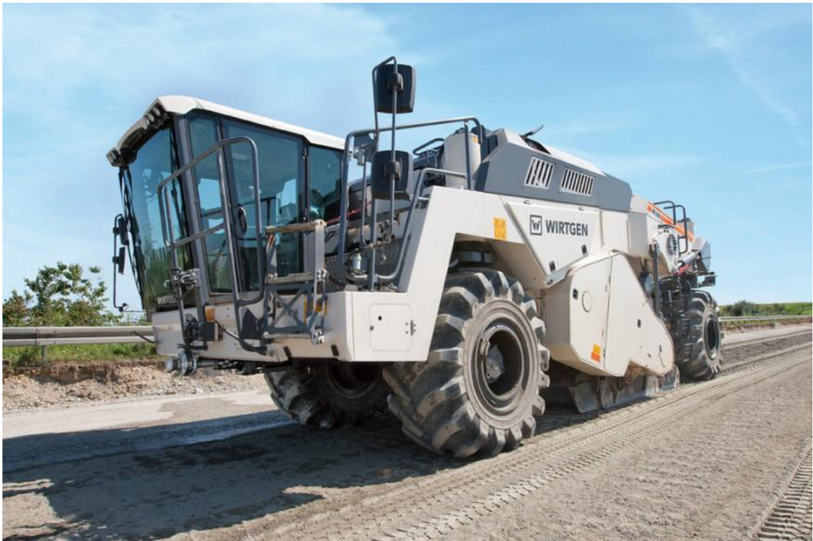
Obrázek 9: Recyklační fréza pro recyklaci za studena WIRTGEN (9)
