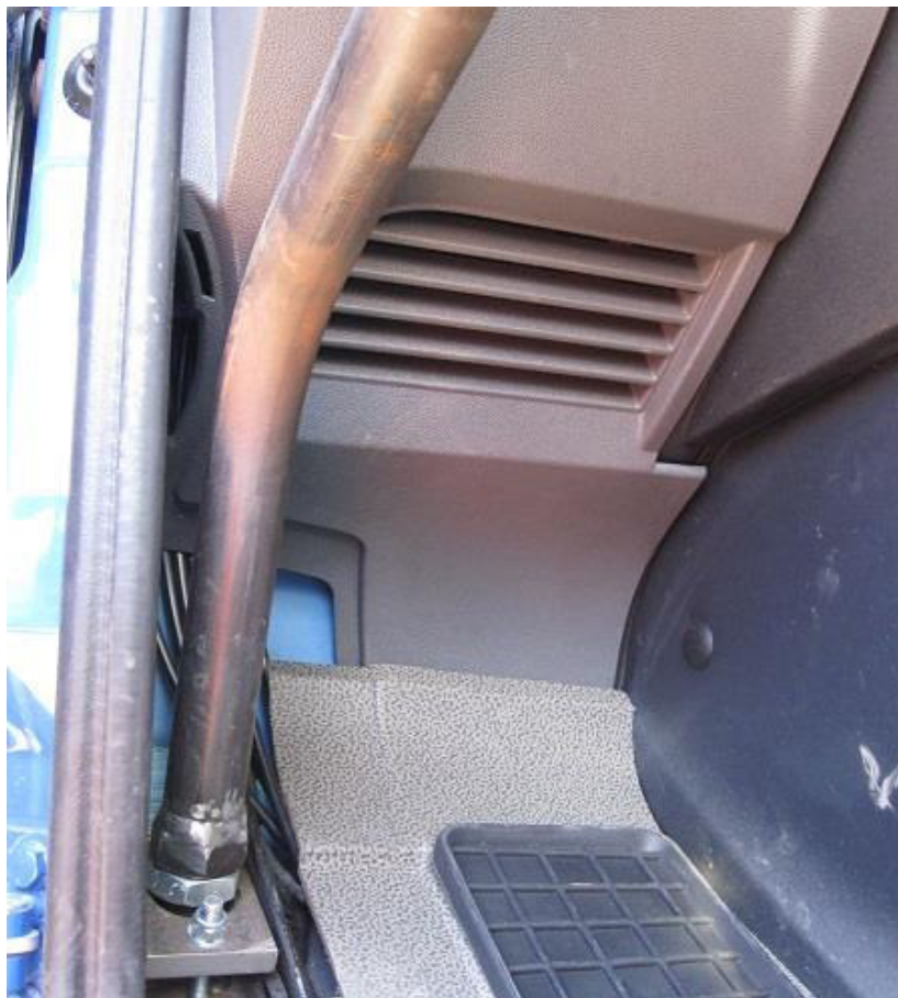
Obrázek 55 – levé přední kotvení
