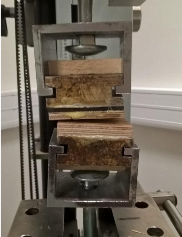
Obr. 29 Zkušební těleso po odtrhové zkoušce
