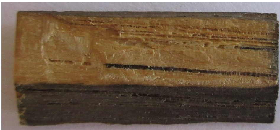
Obr. 27 Hloubka penetrace nanočástic železa do vzorku
