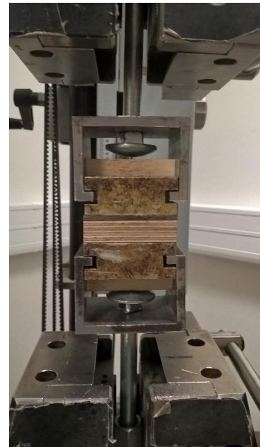
Obr. 21 vzorek s přilepeným přípravkem upnutý do trhacího stroje
