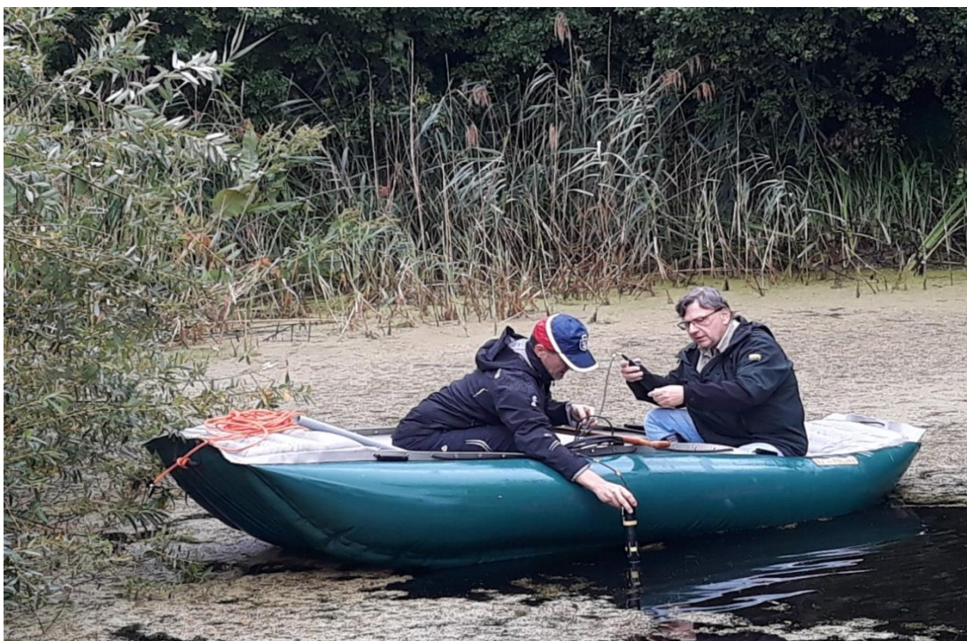
Obr. č. 5: Malá Arazimova tůň, měření vertikální zonace fyzikálně chemických parametrů sondou YSI Professional+ (Pecharová 2019).
