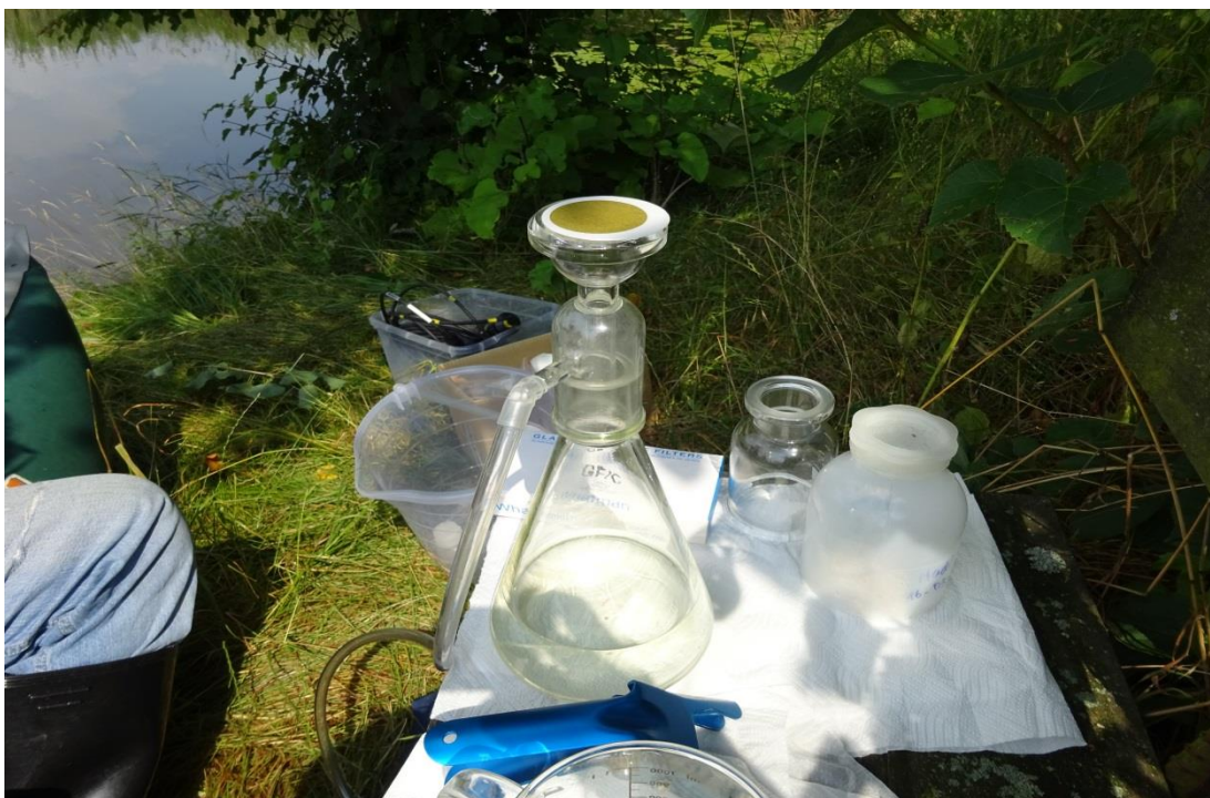
Obr. č. 15: Zachycený seston na filtru Whatman GF/C při filtraci odebraného vzorku vody určeného ke stanovení alkality, koncentrací forem dusíku, fosforu, celkového organického uhlíku a chlorofylu, tůň Poltruba (Pecharová 2019).
