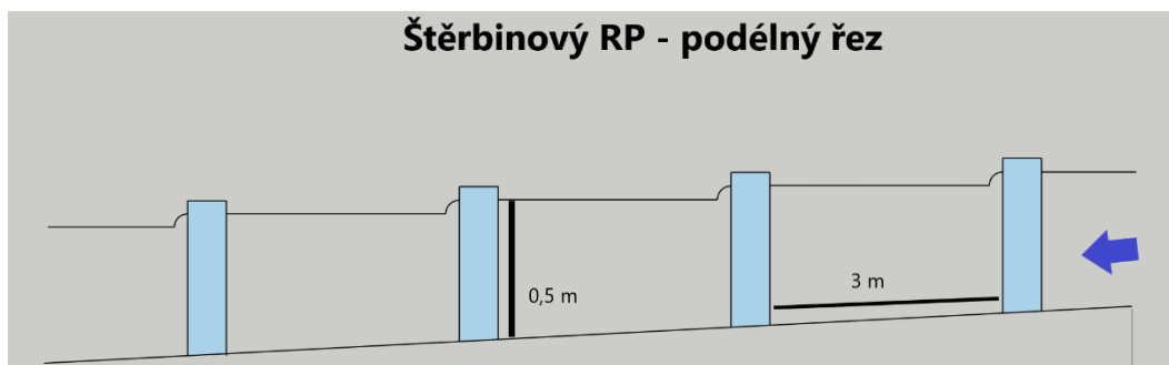
Obr. č. 19: Štěrbínový rybí přechod – podélný řez
