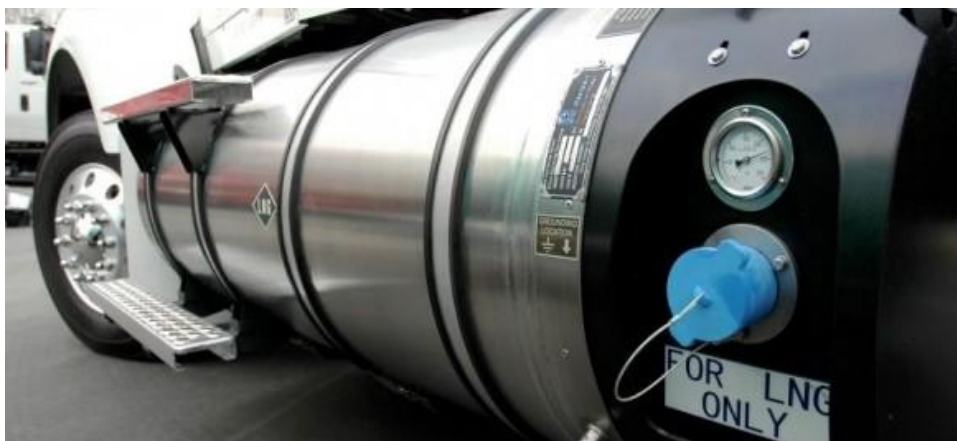
Obr. 2: Nádrž na LNG [9]
