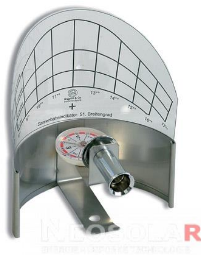
Obr. 3-2 Indikátor sluneční dráhy [21]
